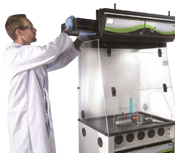
Un filtre saturé n'a plus de site d'absorption libre pour y retenir des molécules.
