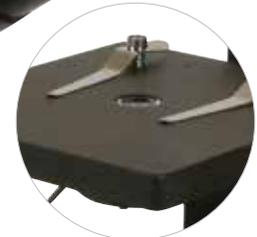
La platine d'une dimension de 132 x 142 mm est équipée d'une surplatine à mouvements orthogonaux (course 75 (X) x 40 (Y) mm avec vernier au 1/10° sur les 2 axes) avec commandes verticales basses. Le modèle référence 571397 existe avec une platine à valets.
