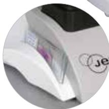
Les range-lames situés de chaque côté du bloc éclairage permettent de stocker jusqu'à 10 lames avant ou pendant l'observation. Pas de perte de lames et paillasse rangée !
