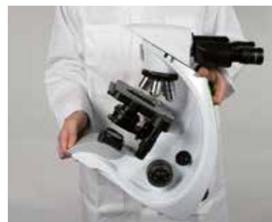
↑ Prise en main et transport faciles. L'encoche à l'avant du statif, combinée à la poignée au dos de l'appareil, assurent un transport sécurisé.
