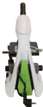
↑ Le range-câble d'alimentation intégré au statif permet le rangement et le transport sans gêne du microscope. Une LED bleue située au centre du range-câble permet à l'enseignant de visualiser la mise sous tension de l'appareil.
