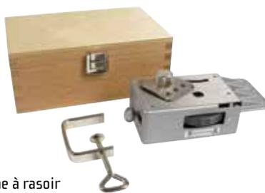
Petit et tout en inox, ce microtome équipé de sa lame à rasoir facilement interchangeable permet l'obtention rapide de coupe de qualité.
