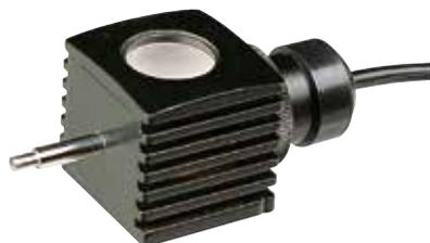
Se monte simplement à la place du miroir sur fiche fendue avec gorge pour maintien par vis. Pour microscopes Collège réf. 571 112 et réf. 571 190 et type PCB réf. 571 141 et LM 900. Livrée avec ampoule 220 V / 20 W, culot B15 à baïonnette Ø 15 mm.
