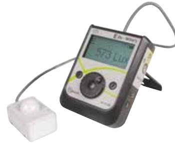
Il mesure l'éclairément lumineux en lux et l'éclairément énergétique en W.m-2. Grâce à sa mémoire intégrée, l'Initio® 2 vous permet d'enregistrer, stocker et restituer ultérieurement des mesures sous format tableur (.csv) via la connexion USB. Sa fonction enregistrement et sa batterie font qu'il est idéal pour des mesures en extérieur.
