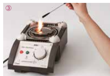
③ Combustion de poudre de zinc
