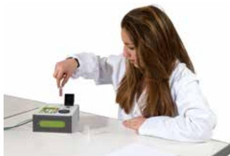
Compact, polyvalent et très simple d'utilisation, ce colorimètre permet de réaliser les mesures et les dosages en transmission (0 à 100%) ou en absorbance.
