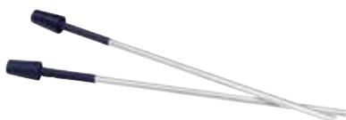
Il permet de déclencher l'acquisition tout en créant un son et générant une onde sonore. Il est très utile pour la détermination de la vitesse du son avec le capteur sonomètre ci-dessus. Il peut servir aussi à l'étude de la sismologie.
