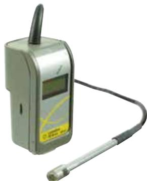
Ce capteur permet la mesure de l'éclairement lumineux jusqu'à 50 kLux grâce à la sonde fournie. Étanche, il s'utilise parfaitement avec le bioréacteur (ref 453064)
