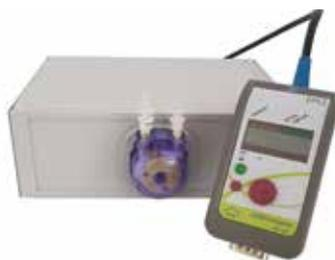
Doté d'une micropompe péristaltique de précision, ce capteur va permettre d'effectuer des prélèvements de solutions de manière précise.
