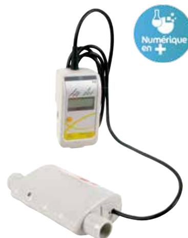
Ce capteur ventilation vous permet de couvrir toutes les mesures pour étudier la respiration humaine. Il permet de réaliser 3 mesures : fréquence, volume et débit respiratoire.
