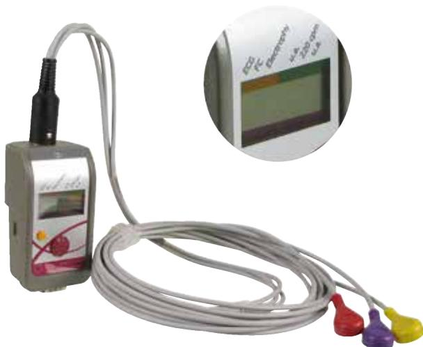
Capteur multifonctions : ECG, EMG et fréquence cardiaque
