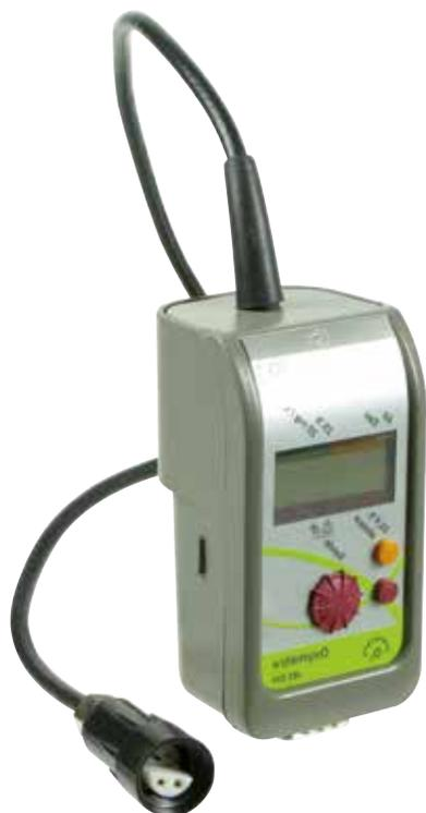
Ce capteur oxymètre air/eau, associé à la sonde O2 présentée ci-contre, vous permet de mesurer la variation du taux d'O2 dans l'air ou dans l'eau.
