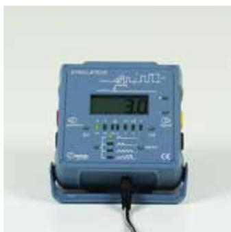
Le stimulateur peut générer tout type de stimulations : uniques, doubles, multiples ou en rampe. Tous les paramètres de la stimulation sont réglables (délai, durée, intervalle, nombre de créneaux, intensité variable). Conçu avec les technologies récentes, il permet de remplacer les stimulateurs d'ancienne génération beaucoup plus encombrants et peu intuitifs.
