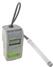
Ce capteur luxmètre vous permet de réaliser des mesures d'intensité lumineuse dans toutes les conditions grâce à ses 2 calibres. Il permet la mesure d'éclairement en intérieur ou en extérieur.
