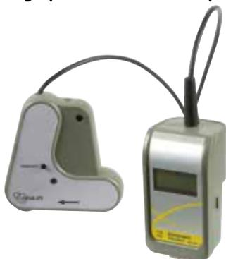
Ce capteur mesure l'écho ultrasonique à 40 kHz et en même temps la distance parcourue. Associé à la maquette Échographie (ci-contre) et au logiciel dédié intégré à l'Atelier Scientifique complet, vous mettez en évidence la forme dissimulée dans la maquette.
