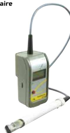
Ce capteur turbidimètre vous permet de mesurer la turbidité d'une suspension et d'en déduire sa concentration en particules. Par extension, il permet donc de calculer une concentration cellulaire dans une solution.
