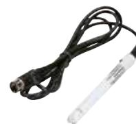
Associée à un capteur ou adaptateur, la sonde éthanol permet d'effectuer des mesures de la concentration en éthanol dans l'air et dans l'eau.
