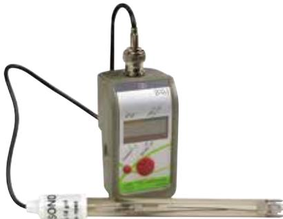
Pour obtenir des mesures précises de concentration en CO<sub>2</sub> aussi bien dans l'eau que dans l'air, optez pour le capteur + sonde CO<sub>2</sub> Air/Eau.
