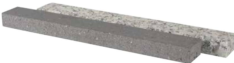
Elles permettent de mettre en évidence la différence de vitesse des ondes en fonction de la nature du matériau. Elles s'utilisent avec un ou deux capteurs Sismo et le clap sonore synchro.
