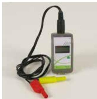
Le capteur physio est un millivoltmètre spécifiquement conçu pour toutes les expérimentations d'électrophysiologie. Il est doté de 4 calibres ( $\pm 250$  mV,  $\pm 50$  mV,  $\pm 10$  mV,  $\pm 1$  mV) pour couvrir une très large gamme de mesures, tout en conservant une haute résolution. Son câble blindé garantit des enregistrements de qualité.
