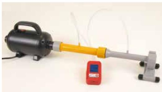
Cette maquette permet de tester la relation de Bernoulli à l'aide de 3 pièces de diamètres différents. Chacune d'elles dispose d'un emplacement de mesure pour des capteurs de pressions (non fournis, voir encadré ci-dessous).
