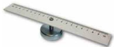
Permet de mesurer la distance entre les lignes de forces par rapport à l'axe de rotation.
