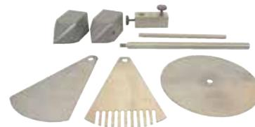
Le ralentissement du pendule ou du disque a pour objectif d'évaluer qualitativement l'existence des courants de Foucault qui prennent naissance dans les matériaux métalliques soumis à un champ magnétique variable. Le contexte du freinage par courant de Foucault peut être abordé.
