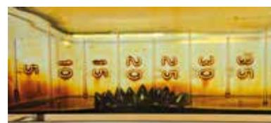
↑ Vue de profil de l'alignement des particules de ferrofluïde.
