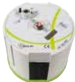
Bouton On/Off Chargement du mobile LED IR de commande des mobiles LED émissive rouge ou verte pour détection des mobiles par caméra Branchement des accessoires de marquage périphérique et centre d'inertie
