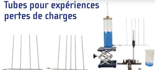
Jeu de 2 éléments en verre formés chacun d'un tube d'écoulement et de tubes manométriques verticaux. Un des éléments présente une réduction de diamètre pour l'étude des pertes de charges locales ou singulières. Mise en évidence de la variation de pression statique lors de l'écoulement d'un liquide.
