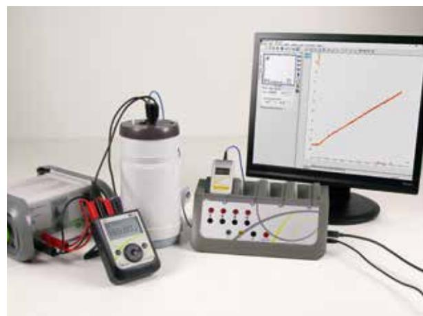
↑ Détermination d'une énergie de changement d'état avec le capteur thermomètre réf. 482101 pour console Foxy et le Joulemètre Initio<sup>2</sup> réf. 292087
