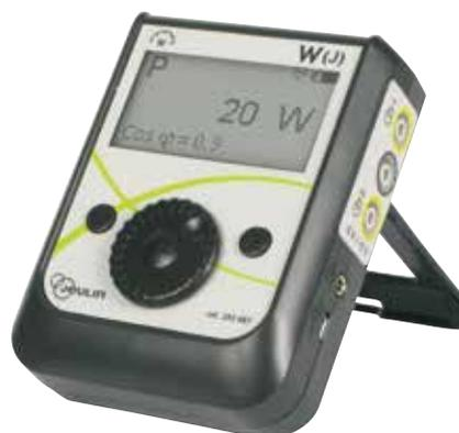
En mode automatique, l'appareil déclenche le comptage de l'énergie lorsque le courant s'établit dans le circuit (I supérieur à 50 mA).
