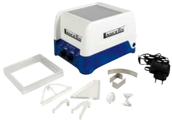
Éclairage : LED ; position continu/synchronisé/libre avec potentiomètre de réglage de la fréquence.
