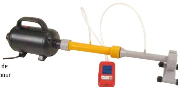
Cette maquette permet de tester la relation de Bernoulli à l'aide de 3 pièces de diamètres différents. Chacune d'elles dispose d'un emplacement de mesure pour des capteurs de pressions (non fournis, voir encadré ci-dessous).
