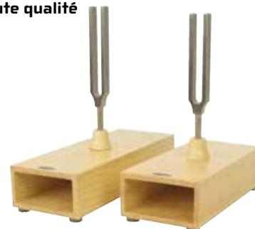
Diapason permettant d'obtenir un signal sonore puissant et de qualité qu'il est possible d'exploiter par oscilloscope ou Ex.AO.
