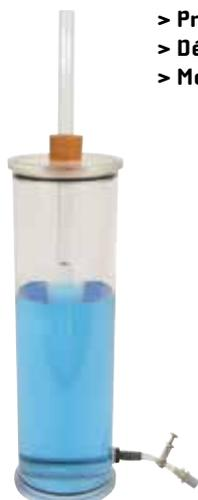
Ce vase, équipé d'un tube de sortie sur lequel est disposé une pince de Mohr pour régler manuellement et simplement la force de serrage, permet d'obtenir un débit à pression constante. Il peut être utilisé comme clepsydre pour la mesure du temps ou comme source associée aux accessoires présentés ci-contre pour l'étude des pertes de charges.
