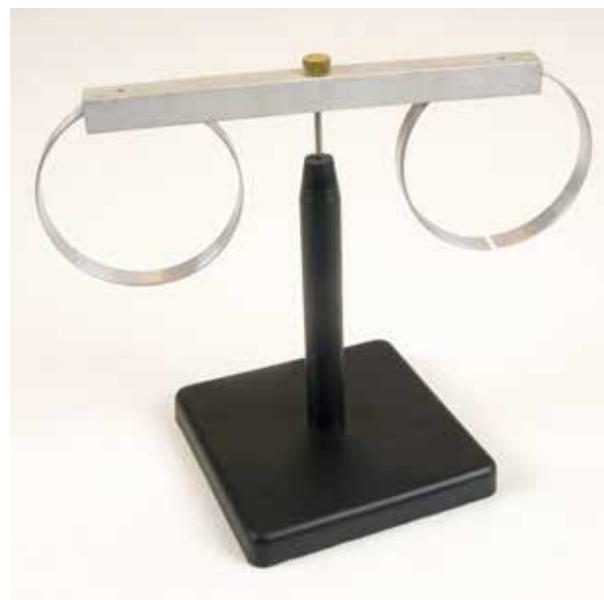
Mettre un aimant en mouvement au travers d'une boucle afin de mettre en rotation le dispositif et ainsi démontrer la loi de Lenz-Faraday.
