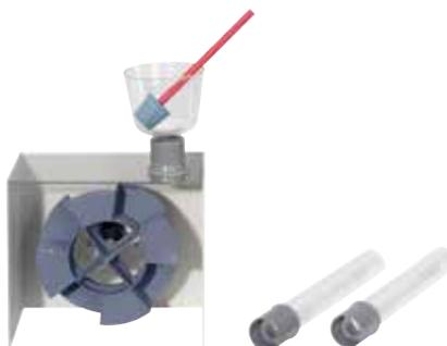
Cette maquette convertit de l'énergie mécanique en énergie électrique à l'aide d'un alternateur de bicyclette.
