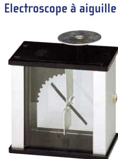
Mise en évidence des charges électriques. Appareil au mécanisme robuste, très sûr de fonctionnement. Déviations spectaculaires.
