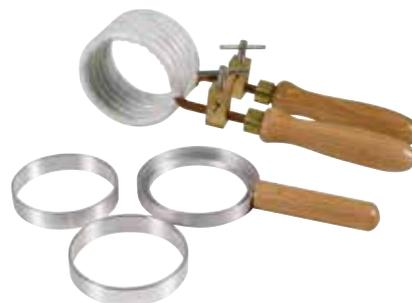
Idéale pour mettre en oeuvre la soudure par point et la mise en évidence des effets thermiques associés à l'induction.
