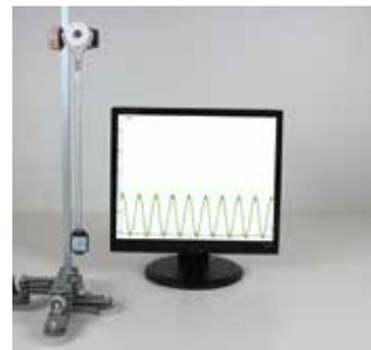
↑ Couplage de l'accéléromètre avec le pendule pesant
