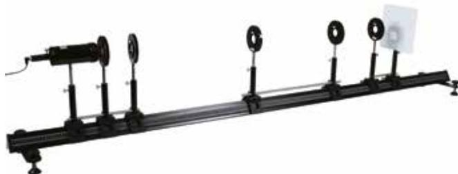
La lunette astronomique, ou 'Lunette de Kepler', permet d'augmenter la taille apparente et la luminosité des objets célestes lors de leur observation. La référence 204149 dispose de cavaliers à colonne percée permettant de fixer l'écartement de chaque système optique (objet à l'infini, lunette astronomique et oeil fictif).
