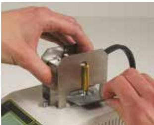
**Étape 2 :** À l'aide de l'encodeur, l'élève renseigne l'épaisseur et la surface correspondant à l'échantillon à tester.
