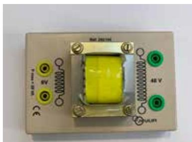
Montés sur support robuste et sérigraphié. Permettent d'étudier le rôle d'un transformateur abaisseur et élévateur pour une utilisation de transport de l'électricité.
