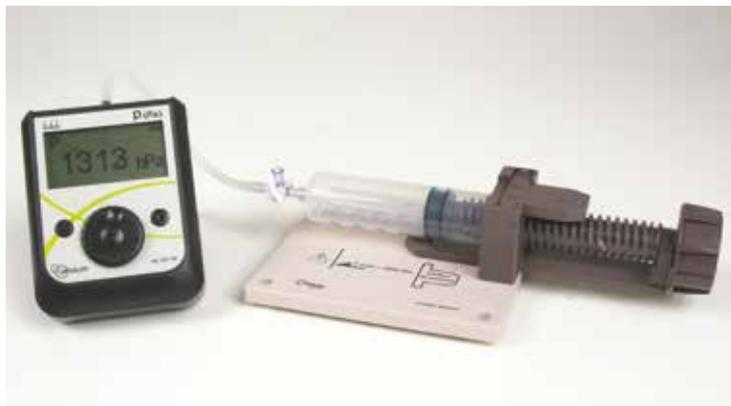
La seringue à piston vissant permet de faire varier le volume et maintenir la pression précisément sans effort. Une butée escamotable permet de limiter la pression afin de protéger le pressiomètre. La vanne 3 voies assure le remplissage de la seringue et la connexion au capteur de pression.
