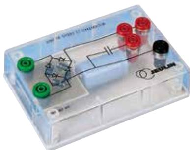
Ce module est constitué d'un pont de diodes acceptant un courant jusqu'à 5 A que l'on peut relier au condensateur de forte capacité (2200  $\mu$ F) à l'aide d'un simple cavalier de sécurité (réf 283424 à commander séparément). Le tout est bien protégé par un boîtier transparent comportant en sérigraphie la symbolique du montage : Le redressement double alternance Nécessaire pour alimenter certains appareils nécessitant un courant de sens constant.
