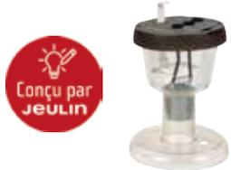
Appareil pour l'étude de l'effet Joule. Cuve en matière plastique isolante et robuste. Socle large pour une bonne stabilité. Alimentation de la résistance chauffante par douilles de sécurité Ø 4 mm. Agitateur intégré au couvercle. Passage pour thermomètre en verre ou sonde de température Ø 6/7 mm. S'adapte directement sur le tableau transfert d'énergie.
