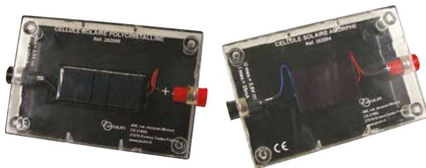
Avec ces cellules, vous déterminez la caractéristique courant-tension de 2 types de cellules solaires. Type de dipôles à utiliser : DEL, dont la consommation est d'environ 20mA, sous 1000W/m<sup>2</sup> celle-ci doit s'allumer.
