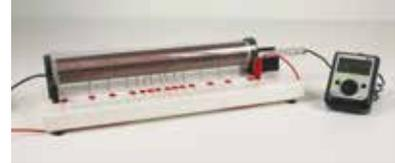
Placer la sonde du Teslamètre Initio®2 réf. 292088 sur le support prévu, en plaçant le 0 sur le repère.
