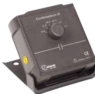
Les différentes valeurs permettent de visualiser l'influence du condensateur sur les oscillations dans un circuit RLC ou d'étudier la charge d'un condensateur.
