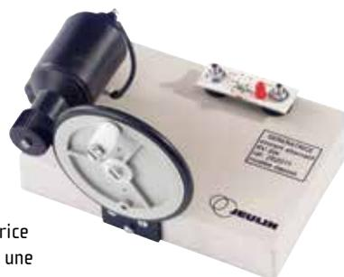
Le signal de la génératrice est visualisé grâce à une DEL UME Éco (à commander séparément).
