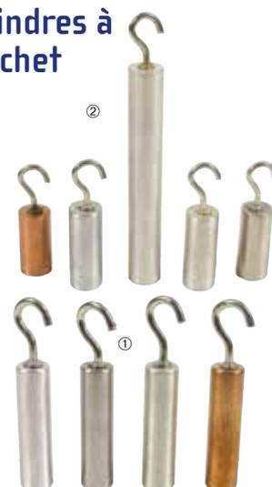
Permet d'étudier la notion de densité et de masse volumique. Le crochet permet de mesurer la force avec un dynamomètre, il permet aussi de réaliser une expérience sur la poussée d'Archimède.
