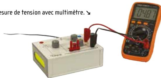
Cette maquette a pour but de réaliser facilement la charge et la décharge d'un condensateur à tension constante.
