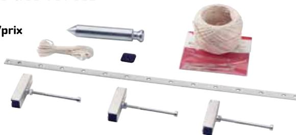
Ensemble de base permettant l'étude des forces. Les forces sont appliquées à l'aide de masses ou de dynamomètres (non fournis) en différents points de la réglette. Le tracé immédiat de chaque figure permet une exploitation simple par l'élève.
