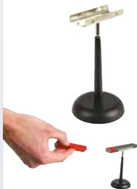
Cet accessoire est idéal pour mettre en évidence des interactions magnétiques. Il suffit de positionner un aimant Ticonal réf. 263 193 sur le support, puis d'approcher un autre aimant pour montrer que 2 pôles de même sens se repoussent alors que 2 pôles opposés s'attirent.
