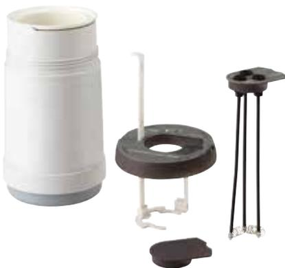
Ce calorimètre est idéal pour déterminer une énergie de changement d'état. L'agitateur intégré et imperdable sera particulièrement utile pour déterminer la chaleur latente de fusion de la glace et la chaleur massique de métaux par exemple. Les 3 valeurs de résistances à connectique douilles sécurisées permettent de nombreuses conditions expérimentales et l'orifice pour thermomètre est compatible avec les capteurs thermomètre Ex.A.O. ou thermomètres à liquides à immersion partielle.
