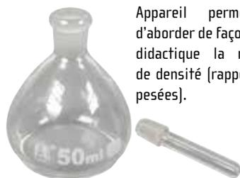
Appareil permettant d'aborder de façon très didactique la notion de densité (rapport de pesées).
