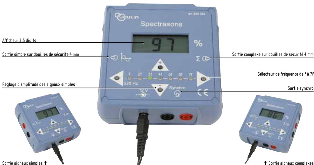
Le Spectrasons a été conçu pour identifier les paramètres influents dans les notions de timbre et hauteur par l'écoute de sons et l'analyse des signaux, tout en permettant une approche didactique de l'analyse spectrale.
