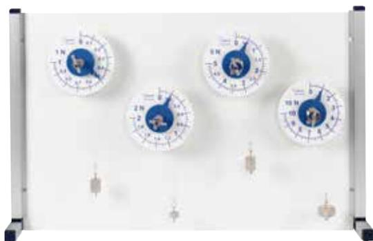
La force exercée agit sur un ressort fixé sur une poulie montée sur roulement à bille. Le réglage du zéro se fait par rotation du disque gradué autour de son axe. Une vis métallique située à l'arrière du disque permet la fixation d'un support magnétique (à commander séparément) pour une utilisation sur panneau métallique.
