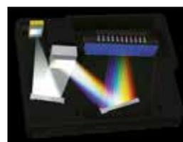
Le faisceau lumineux traverse une fente située au plan focal d'un miroir sphérique : tous les faisceaux réfléchis par le miroir sont donc parallèles. Ces derniers sont ensuite diffractés par un réseau permettant la séparation du spectre en ses différentes composantes. Pour finir, chaque longueur d'onde est focalisée par un second miroir sur une barrette CCD.
