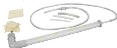
Tube gradué tous les 50 mm muni à une extrémité d'une capsule Ø 40 mm à membrane souple. Un tube coaxial permet la rotation de la capsule sans se mouiller les doigts. La sonde se connecte directement à un dispositif de mesure de pression.
