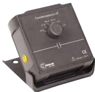
Les différentes valeurs permettent de visualiser l'influence du condensateur sur les oscillations dans un circuit RLC ou d'étudier la charge d'un condensateur.
