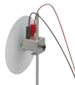
Ce dispositif est équipé d'un disque à 7 secteurs de couleur, rappelant les couleurs obtenues lors de la décomposition de la lumière blanche avec un prisme.
