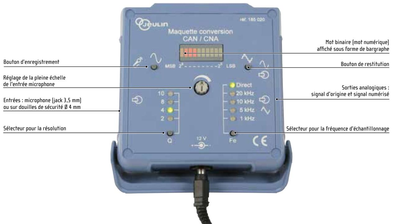
Grâce à cette maquette l'élève est confronté à une démarche progressive pour comprendre le principe de la conversion analogique-numérique et numérique-analogique.
