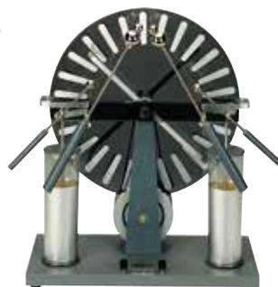
Cette machine se compose de 2 disques transparents munis de segments métalliques radiaux, de 2 bouteilles de Leyde et de 2 bras de décharges, le tout monté sur un plateau. La production et la collection des charges sont assurées par le frottement de balais métalliques sur les disques en rotation. Les bouteilles de Leyde peuvent être reliées aux bras de décharge pour stocker les charges. La différence de potentiel entre les bras permet d'obtenir des étincelles très démonstratives.
