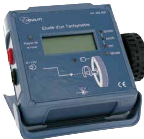
Cet appareil est spécialement conçu pour étudier l'influence du diamètre d'une roue et de son régime sur la vitesse de rotation. Équipé de son propre moteur et d'un tachymètre en interne, ce produit est très complet et permet des mesures de régime de rotation sans contact. Il est également utilisable pour des manipulations sur le freinage d'un moteur à courant continu. À compléter par une alimentation pour faire varier la vitesse de rotation.
