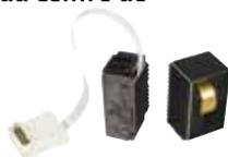
Cet accessoire permet de tracer la trajectoire d'un point du mobile situé à sa périphérie. Une masse coulissante permet de compenser le déplacement du centre d'inertie du mobile.
