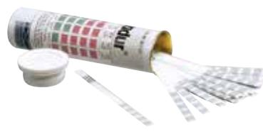
Ces bandelettes permettent une mesure de la dureté des eaux sur un large domaine de mesure (jusqu'aux eaux très dures : 3.9 mMol/L).
