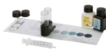
Kit pour la détermination colorimétrique des ions phosphates dans les eaux de surface et les eaux usées.
