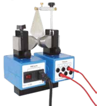
▲ Réalisation du freinage par courant de Foucault
