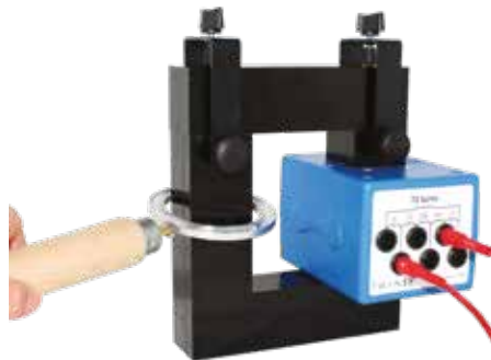
▲ Réalisation d'un chauffage par induction
