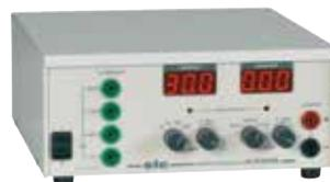
Ce produit possède l'avantage de disposer d'une fonction alimentation et générateur de courant combiné.
