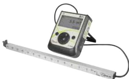
Ce teslamètre mesure l'intensité du champ magnétique sur deux axes et selon deux calibres. Il est adapté à une utilisation par les élèves et est compatible avec le solénoïde réf. 292012 et la bobine à écartement variable réf. 292014.
