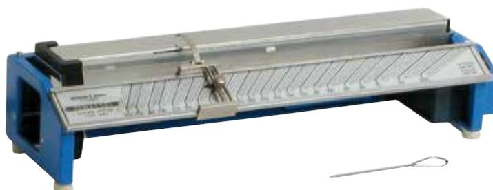
Appareil constitué d'un bloc métallique en acier inoxydable chauffé de façon dissymétrique.
