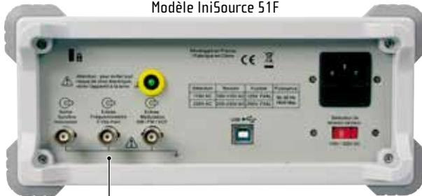
Accès aux entrées Fréquence-mètre et Modulation AM/FM/VCF, et à la sortie Synchro Vobulation
