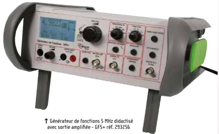
↑ Générateur de fonctions 5 MHz didactisé avec sortie amplifiée - GF5+ réf. 293256
