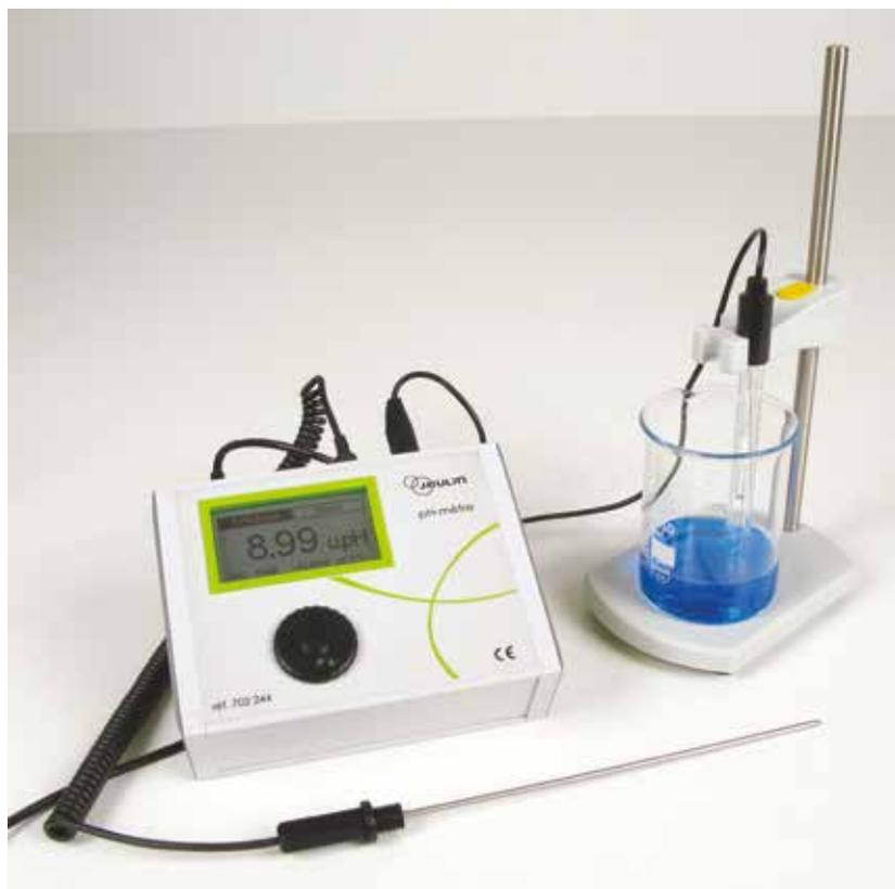
Ce pH-mètre peut être exploité en appareil de mesure ou connecté à un PC.
