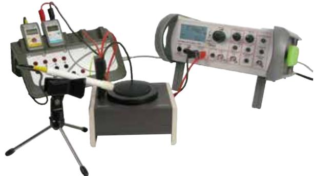
Fréquence réglable de 1mHz à 5 MHz sur 5 gammes ou en mode Automatique
