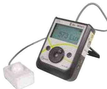
Il mesure l'éclaircissement lumineux en lux et l'éclaircissement énergétique en W.m-2. Grâce à sa mémoire intégrée, l'Initio® 2 vous permet d'enregistrer, stocker et restituer ultérieurement des mesures sous format tableur (.csv) via la connexion USB. Sa fonction enregistrement et sa batterie font qu'il est idéal pour des mesures en extérieur.
