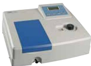
D'une prise en main intuitive, il se prête à une utilisation par les élèves en TP. Ce spectrophotomètre permet de réaliser le balayage en longueur d'onde manuellement en actionnant une molette graduée. La mesure d'absorbance ou de transmission est lue directement sur l'affichage lumineux situé en façade de l'appareil.
