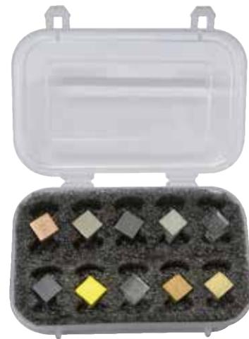
Déterminer la densité du matériau étudié. La dimension d'1 cm<sup>3</sup> permet, à partir de la masse obtenue avec une balance, de déterminer la masse volumique en kg/m<sup>3</sup> du matériau étudié par une simple multiplication par 1000.
