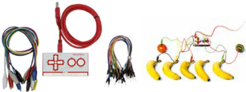
Transformez par exemple des bananes en touches de piano ou de la pâte à modeler en manette de jeu. Facile à mettre en place grâce aux câbles et pinces crocodiles. Le Makey Makey utilise le principe de commutation à résistance élevée pour détecter une connexion. Compatible avec Arduino™ et les logiciels Scratch et mBlock.
