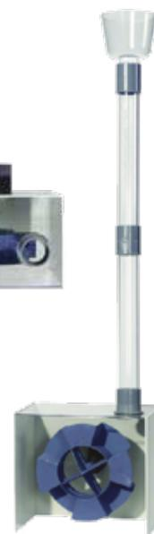
Cette maquette convertit l'énergie mécanique en énergie électrique à l'aide d'une turbine qui entraîne un alternateur de bicyclette. Avec l'énergie produite, plusieurs usages sont possibles : mesure de la tension avec un multimètre, alimentation d'une LED. La turbine peut être placée sous un courant d'eau pour entretenir l'énergie produite.
