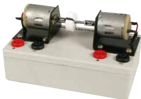
2 moteurs électriques à courant continu sont reliés mécaniquement au niveau de leurs arbres de sortie. L'un fonctionne donc en moteur, tandis que l'autre se comportera en générateur. L'élève réalise ainsi une conversion électrique-mécanique qui se traduira par la rotation de l'arbre moteur, le disque stroboscopique facilite l'observation. Puis il réalise une conversion mécanique-électrique par le biais de la génératrice pour produire une tension, qu'il pourra utiliser pour alimenter un dipôle.
