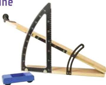
Réglage de l'angle d'inclinaison. Compact et facile à utiliser. Avec ce plan incliné, vous mettez en œuvre des mouvements rectilignes uniformément variés. Le mouvement se fait soit en descente avec une pente dont l'angle est réglable à l'aide d'un rapporteur, ou d'une masse à crochet pour entraîner le chariot avec une force constante. Des accessoires permettent également d'aborder des interactions comme les frottements.
