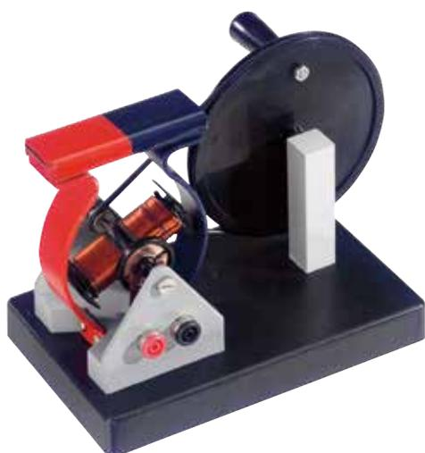
La bobine est mise en rotation par l'action d'une manivelle. La transmission se fait par une courroie. La sortie sur douilles de sécurité laisse la possibilité de connecter différents appareils pour la visualisation du signal produit.
