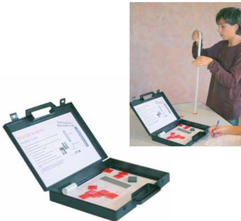
Avec la mallette dureté réf. 270408, à l'aide d'un pointeau l'élève va pouvoir apprécier l'impact sur les différents matériaux et en déduire les plus durs.
