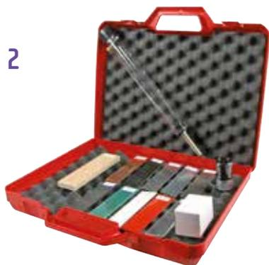
Étude de métaux, alliages et plastiques. Multitude d'essais réalisables (pliage, formage, usinage, oxydation, conductivité, dureté).
