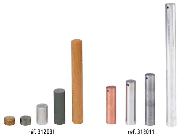
Jeu de cylindres de masse égale permettant la comparaison des masses, l'introduction de la notion quantitative et qualitative de masse volumique et l'appréhension visuelle des différentes densités des métaux.
