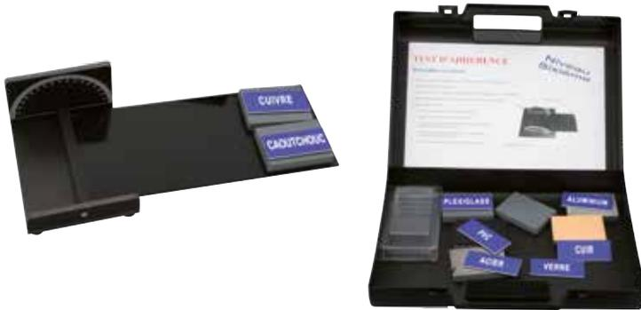
Avec la mallette adhérence réf. 600917, l'élève va identifier chaque matériau grâce aux étiquettes nominatives. Il observera l'adhérence de ces matériaux à l'aide d'un plan incliné, d'un rapporteur d'angle et différents mobiles de même masse avec des revêtements différents (métal, plastique, cuir, caoutchouc). On peut même varier l'étude sur sol mouillé.
