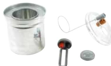
Ce calorimètre est composé de deux enceintes en aluminium, séparées par un vase en polystyrène pour renforcer l'isolation, le tout étant maintenu par une couronne en plastique. Le couvercle transparent dispose d'ouvertures prévues pour un thermomètre Ø 6 mm, pour l'agitateur et pour un support de résistance avec connexion par douille de sécurité. Un jeu de 3 résistances de valeurs différentes permet de faire varier la puissance de chauffe.
