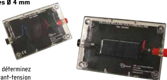
Avec ces cellules, vous déterminez la caractéristique courant-tension de 2 types de cellules solaires.
