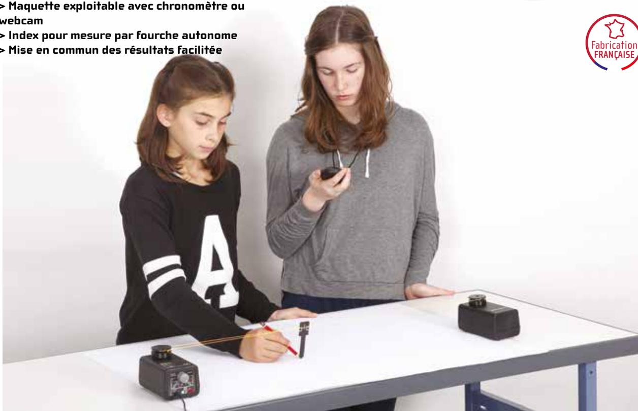
Avec cette maquette, l'élève caractérise des mouvements rectilignes et circulaires (Direction, Sens, Vitesse).
