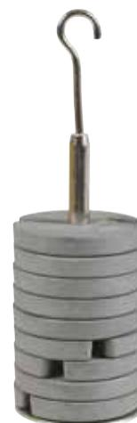
Ces masses échancrées sont idéales pour les TP de mécanique statique.
