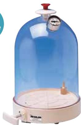
Cloche en plastique transparent munie d'un manomètre à dépression gradué de 0 à - 1 Bar. La Pompe à main incorporée dans l'embase possède une sortie pour branchement d'un tuyau à vide  $\varnothing$  intérieur 5 mm (non fourni). Nécessite un sonomètre pour mesurer l'atténuation.
