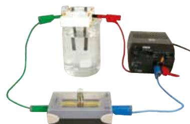
↑ Le support universel pour électrodes est posé directement sur un bécher contenant de l'eau qui conduit mal l'électricité (l'ampoule ne s'allume pas).
