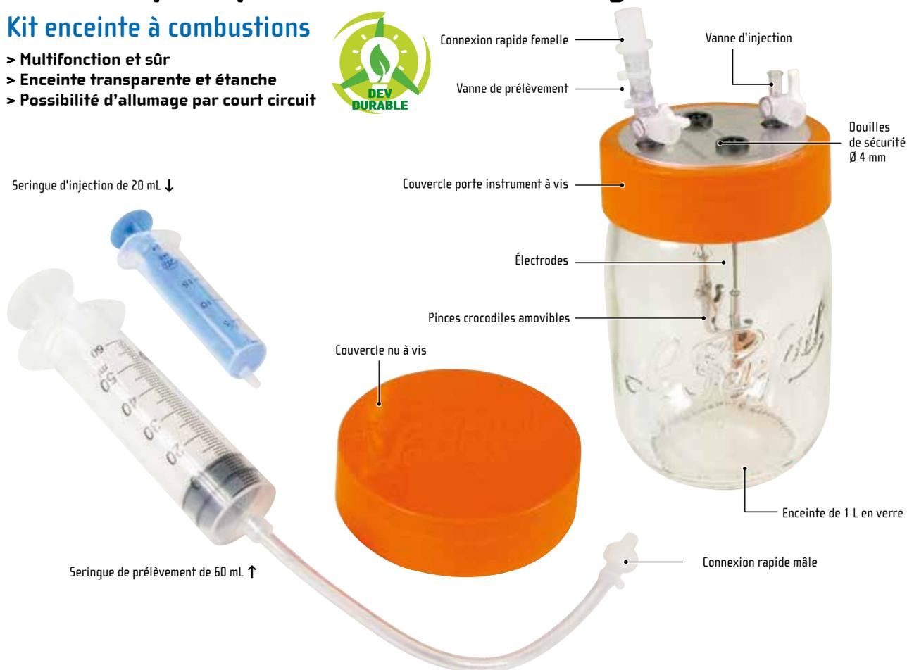
Ce kit permet de réaliser des activités expérimentales mettant en œuvre une transformation chimique : la combustion (du fer ou du carbone). Grâce à l'étanchéité de l'enceinte, il est possible d'observer l'influence de l'oxygène sur la combustion : - différence entre l'air et l'oxygène pur, - arrêt de la combustion lorsqu'il est épuisé. Le système d'injection et de prélèvement donne différentes possibilités d'analyse des gaz résultants de la combustion.
