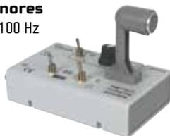
Mesure de la vitesse des ultrasons avec l'émetteur télémetre et le récepteur Moduson<sup>®</sup> 2. ↓
