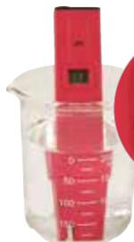
1 - Verser de l'acide chlorhydrique 1 mol/L dans un bécher et mesurer le pH.
