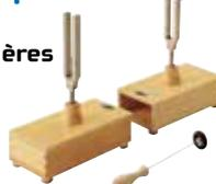
Ces 2 diapasons sont montés sur caisses de résonance et livrés avec 2 masses à glissière et 1 marteau. Les masses permettent de modifier la fréquence du diapason de 394 Hz à 440 Hz. Vous réaliserez facilement les expériences de propagation (résonance) et de battements acoustiques. 1 microphone et 1 oscilloscope seront les compléments utiles pour visualiser les caractéristiques physiques des sons émis par les diapasons.
