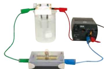
↑ L'ampoule s'allume, la conductivité a augmenté.
