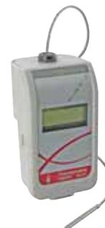
Ce capteur vous permet de réaliser des mesures de température de -50 °C à +150 °C. La sonde est immergeable. Le temps de réponse réduit associé à la plage de mesure optimisent les résultats lors d'études sur les changements d'état.
