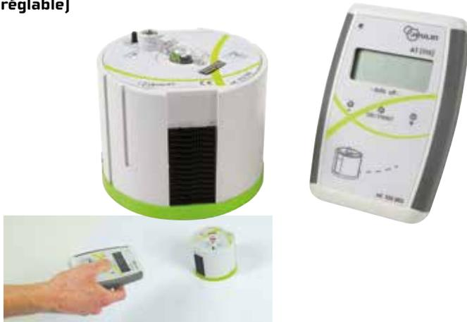
Ce mobile à coussin d'air permet d'étudier des mouvements sans frottement. Une solution de marquage innovante par jet d'encre, piloté à distance par télécommande infrarouge, permet de tracer sur une feuille de papier standard, la trajectoire du mobile. Une DEL configurable (rouge ou verte) permet de suivre facilement le mobile avec une caméra et d'effectuer le traitement de la séquence afin de caractériser le mouvement.
