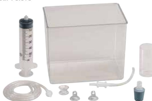
Réalisez la manipulation de dégazage d'une eau pétillante et récupérez le gaz par la méthode du déplacement d'eau.
