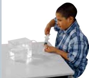
Prélèvement du gaz recueilli à l'aide d'une seringue. ←
