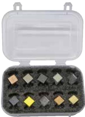
Avec ce kit, vos élèves déterminent très facilement la densité du matériau étudié par pesage. La dimension d'1 cm<sup>3</sup> permet de déterminer très facilement la masse volumique en kg/m<sup>3</sup> de matériaux (métaux, plastiques, minéraux).
