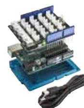
La carte Arduino™ Uno est basée sur le microcontrôleur ATmega328. L'interface se programme à l'aide de l'IDE Arduino
