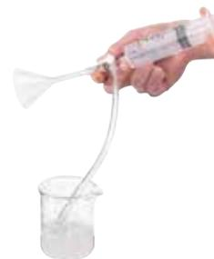
2- Aspiration des gaz de combustion du butane à l'aide de la seringue.
