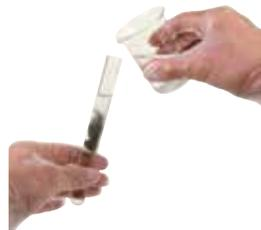
2 - Mettre de la laine de fer et verser l'acide chlorhydrique dans le tube à essai.
