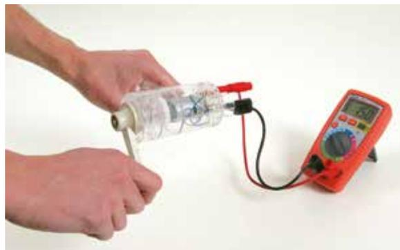
Faire tourner la manivelle à la main, augmenter la vitesse pour vérifier que la tension augmente. Dans le même temps, l'ampoule qui s'éclaire permet d'évaluer l'énergie produite.
