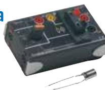
Boîtier complet permettant de tracer la caractéristique d'un dipôle ohmique. La sérigraphie permet un branchement simple et sans risque d'erreur de l'ampèremètre et du voltmètre. Un potentiomètre est intégré à la maquette afin de faire varier la tension de 1,3 V à 9 V environ. Un connecteur polyvalent, de type haut-parleur, assure le branchement des dipôles ohmiques (voir page 201 pour les résistances nues). Un accessoire permet de fixer des ampoules culot E10,
