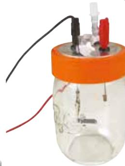
↑ Enceinte combustion réf 253140 : combustion du carbone et mise en évidence du CO<sub>2</sub> (précipité eau de chaux)
