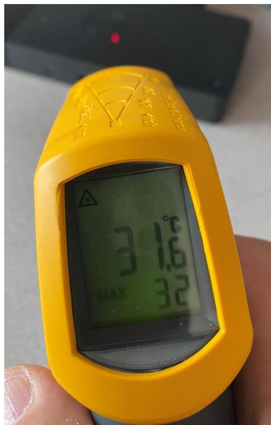
Mesure sur un transformateur avec vidée laser et mémorisation du maximum
