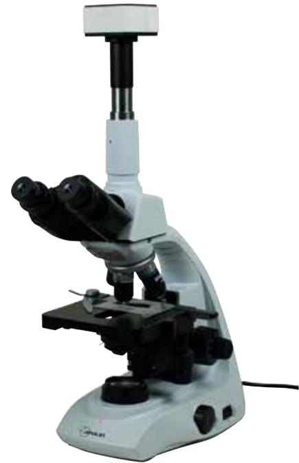
Exemple de montage sur tube trinoculaire
