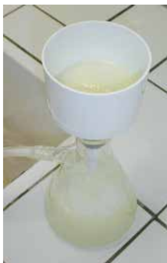
↑ Filtration sous vide en fin de synthèse.
