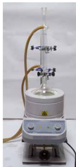
↑ Recristallisation à chaud des cristaux d'aspirine.
