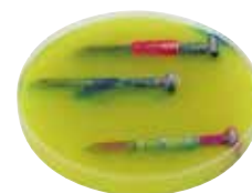
↑ Clou + cuivre Clou seul Clou + aluminium
