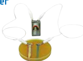
↑ Mise en évidence de la protection cathodique
