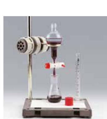
↑ Exemple de support pour montages légers particulièrement adapté pour la Microchimie (réalisé à partir du support Modumontage économique)
