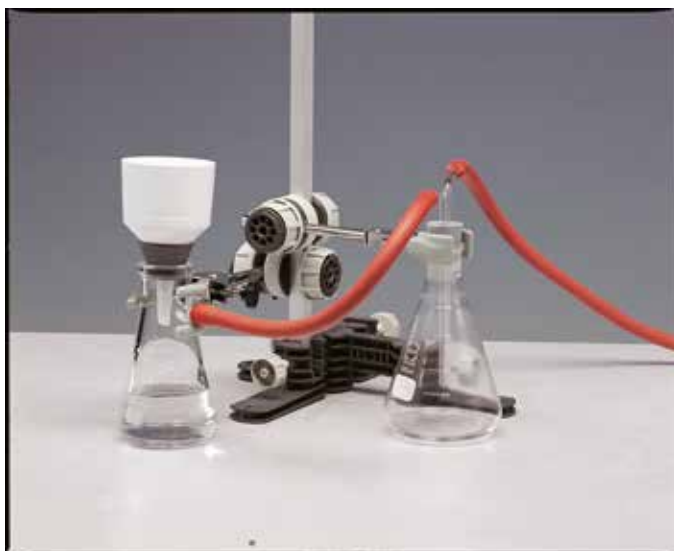
↑ Exemple de support pour montage de filtration sous vide (réalisé à partir du statif Modumontage)
