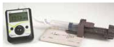
La seringue à piston vissant permet de faire varier le volume et maintenir la pression précisément sans effort. Une butée escamotable permet de limiter la pression afin de protéger le pressiomètre. La vanne 3 voies assure le remplissage de la seringue et la connexion au capteur de pression.
