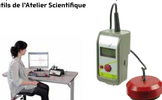
Ce capteur permet de mesurer l'onde générée par un choc. Il est directement reconnu par l'Atelier Scientifique, vous réalisez ainsi très simplement des courbes exploitables par l'élève. Avec 2 capteurs Sismo ou un capteur Sismo et un adaptateur Synchro, vous mettez en évidence le décalage entre les 2 signaux et vous calculez la vitesse de l'onde. Il est possible par la suite de comparer les résultats obtenus pour différents matériaux.
