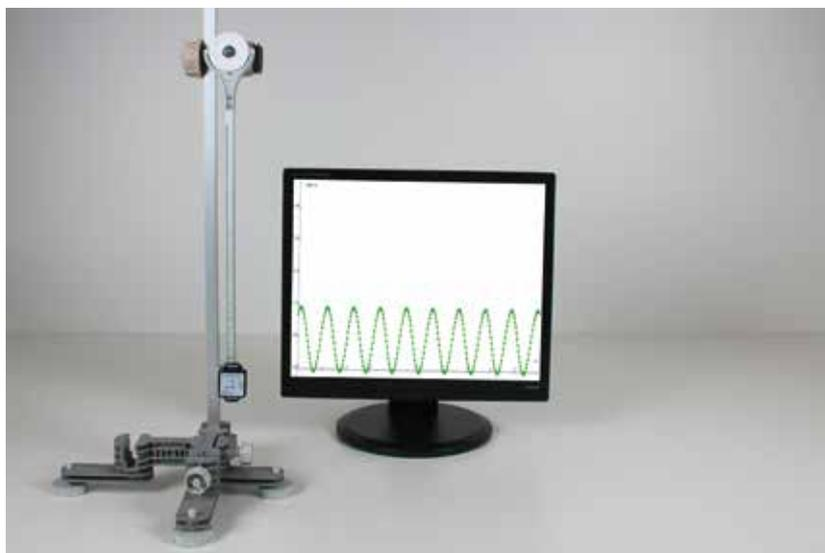
L'accéléromètre sans fil est une véritable centrale inertielle conçue pour mesurer des accélérations sur 3 axes, des vitesses angulaires autour de ces 3 axes, ainsi que les angles d'inclinaison correspondants.
