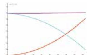
Calcul des énergies potentielles, cinétique et mécanique à partir de l'enregistrement vidéo de la chute d'une bille. Le nombre important de points permet d'effectuer des calculs précis.
