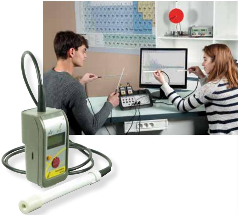
Ce capteur permet l'acquisition d'un signal sonore et la mesure du niveau d'intensité sonore en décibels grâce à son microphone amplifié intégré. Associé aux outils du logiciel Atelier Scientifique, il est idéal pour réaliser l'analyse spectrale d'un son.
