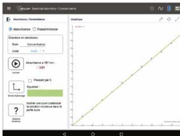
▲ Courbe de Beer-Lambert pour mesure de concentration d'une solution inconnue
