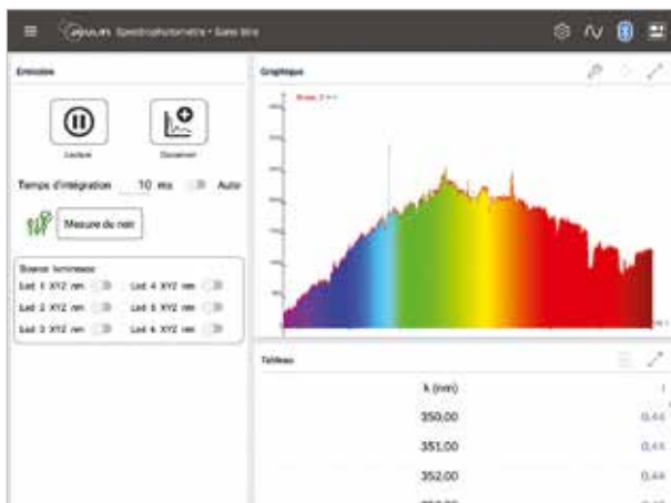
▲ Spectre d'émission d'une lampe avec l'option de couleur de l'aire de la courbe
