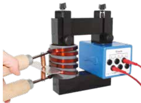
▲ Réalisation d'un point de soudure
