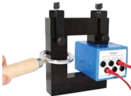
▲ Réalisation d'un chauffage par induction
