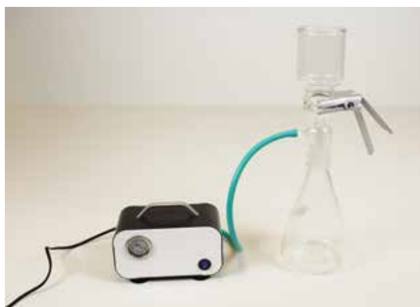
Filtration sous vide avec la pompe réf. 240080
