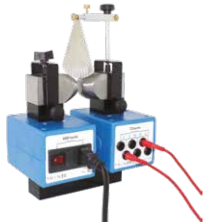
▲ Réalisation du freinage par courant de Foucault
