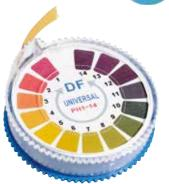
Plage de mesure : pH 1 à 14 Livré en rouleau de 5 m dans un boîtier distributeur avec échelle de teinte.
