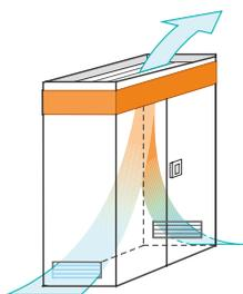
L'air de l'armoire est aspiré mécaniquement et passe à travers un filtre qui fixe les polluants, l'air est ainsi purifié et recyclé dans la pièce.
