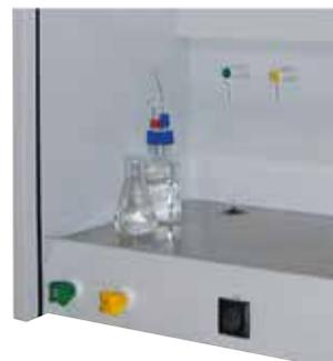
\*Postes de travail pour produits dangereux selon DIN 12924-4: 2012 - Ne remplace pas une sorbonne selon DIN EN 14175. Ne convient pas aux travaux avec des charges acides élevées ni aux travaux de fusion à hautes températures.
