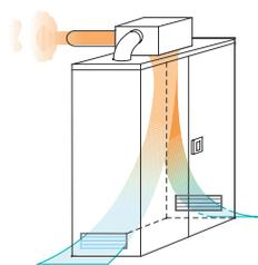
L'armoire est raccordée à l'extérieur du bâtiment via un conduit et l'air contenu dans l'armoire est expulsé mécaniquement en continu.
