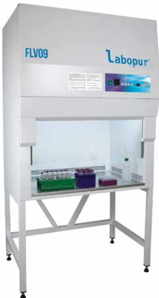
Une hotte à flux laminaire est conçue pour éviter la contamination d'un échantillon par des particules ou par une contamination microbienne.
