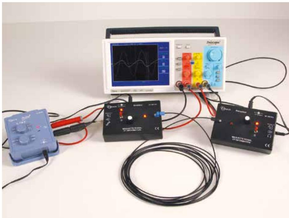
↑ Propagation d'une information entre émetteur et récepteur au travers d'une fibre optique
