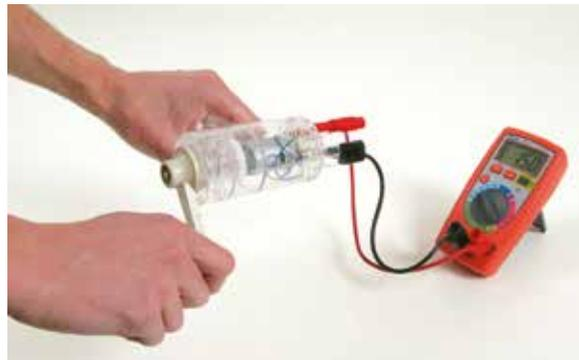
Faire tourner la manivelle à la main, augmenter la vitesse pour vérifier que la tension augmente. Dans le même temps, l'ampoule qui s'éclaire permet d'évaluer l'énergie produite.
