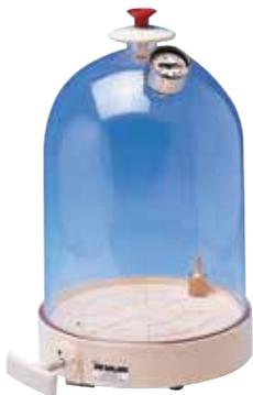
Cloche en plastique transparent munie d'un manomètre à dépression gradué de 0 à - 1 Bar.
