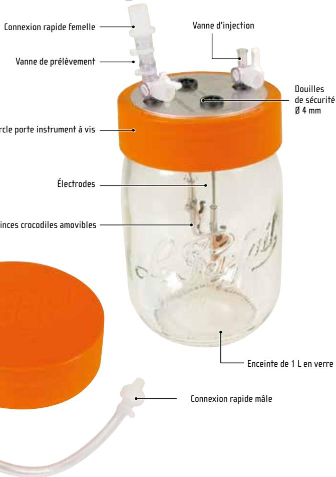
Ce kit permet de réaliser des activités expérimentales mettant en œuvre une transformation chimique : la combustion (du fer ou du carbone). Grâce à l'étanchéité de l'enceinte, il est possible d'observer l'influence de l'oxygène sur la combustion :
