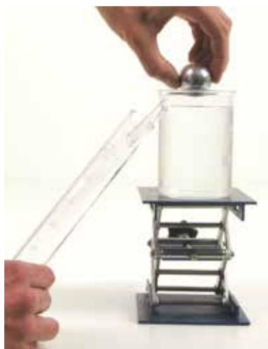
↓ Récupération du trop plein dans l'éprouvette graduée pour déterminer le volume de l'objet
