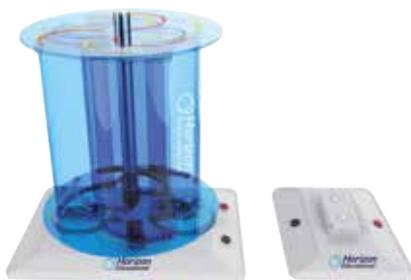
Cette éolienne permet d'étudier la conversion d'énergie mécanique en énergie électrique. Elle est modulaire, l'élève peut concevoir une éolienne avec plusieurs configurations possibles (2, 3 ou 4 pales). Un système électromagnétique permet de générer une énergie électrique pour alimenter une DEL.
