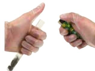
4 - Approcher une flamme près de l'entrée du tube à essai. Une petite détonation se produit. Elle est caractéristique du gaz dihydrogène ( $H_2$ ) qui brûle.
