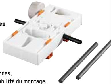
Ce support universel assure le maintien des électrodes, la connexion électrique et garantit une parfaite stabilité du montage. Il existe 2 méthodes d'utilisation :
