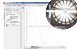
Graphique des positions en fonction du temps dans le cas d'un mouvement circulaire uniforme
