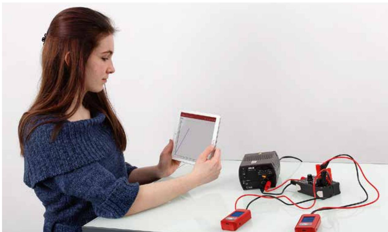
Cette expérience a pour but d'étudier les variations de l'intensité du courant électrique dans un circuit contenant une résistance quand on augmente la tension à ses bornes.
