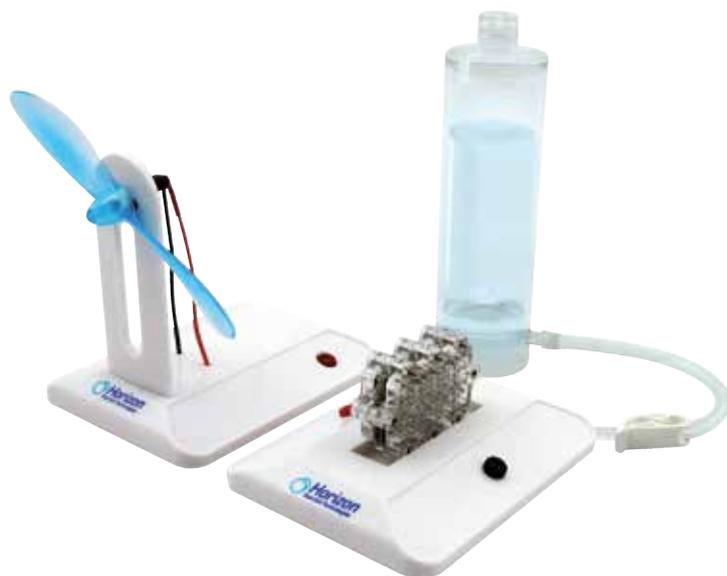
Cette pile à combustible est compatible avec une source d'éthanol qui fournit l'hydrogène nécessaire à son fonctionnement. La source peut être constituée d'un mélange d'éthanol et d'eau ou d'éthanol issu de la biomasse par un procédé de fermentation de ressources renouvelables agricoles comme le blé, le maïs, la paille... L'élève peut évaluer l'impact de la concentration, de la température de la solution, et de la nature de la source, en remplaçant l'éthanol par du vin ou de la bière.
