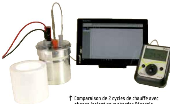
↑ Comparaison de 2 cycles de chauffe avec et sans isolant pour aborder l'énergie thermique et les gaspillages.
