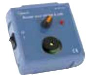
Ce buzzer monté sur une mousse pour éviter toute propagation du son par vibration, est idéal pour mettre en évidence la décroissance du son lors d'une baisse de pression pour justifier que le son a besoin d'un milieu matériel pour se propager.
