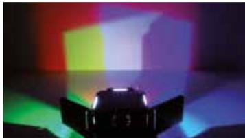
Cette source est l'outil idéal pour l'étude des couleurs grâce à ses 2 volets à miroirs rabattables et aux 3 porte-filtres permettant de positionner des filtres de couleur au format diapositive 50 x 50 mm. Elle peut aussi être utilisée en source à faisceaux parallèles pour une utilisation avec des lentilles de démonstration.
