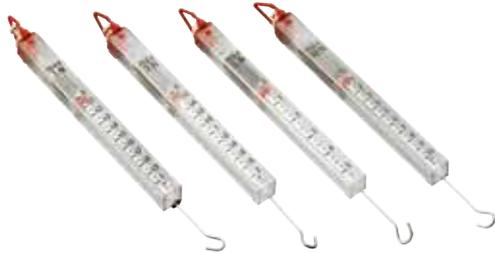
Dynamomètres pouvant être utilisés dans l'eau.
