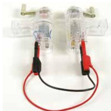
En reliant électriquement entre eux 2 générateurs électriques manuels, vous réalisez une conversion mécanique-électrique, puis électrique-mécanique. Ainsi il est possible d'évaluer qualitativement le transfert d'énergie et les pertes.
