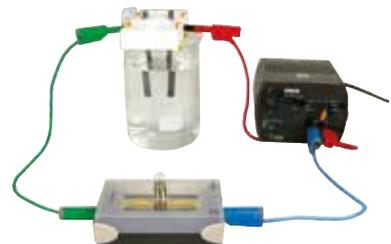
↑ Le support universel pour électrodes est posé directement sur un bécher contenant de l'eau qui conduit mal l'électricité (l'ampoule ne s'allume pas).
