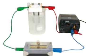
↑ L'ampoule s'allume, la conductivité a augmenté.
