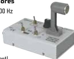
Mesure de la vitesse des ultrasons avec l'émetteur télémetre et le récepteur Moduson<sup>®</sup> 2. ↓
