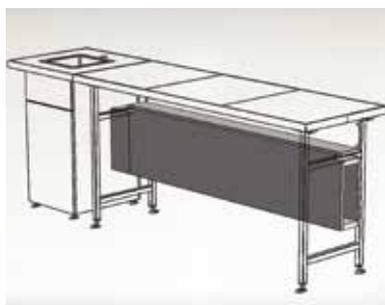
Ces caissons sont destinés à raccorder des paillasse humides au réseau lorsque les attentes se trouvent au mur et le plot d'eau à l'extrémité opposée de la paillasse.
