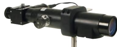
Cette lunette vous permettra d'introduire la notion d'autocollimation et la réalisation des principales expériences de focométrie.
