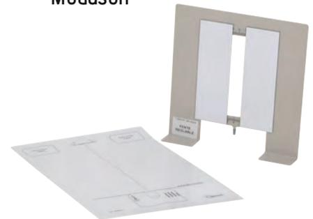
Dispositif muni d'une fente réglable de 0 à 40 mm permettant de visualiser les minima et maxima de diffraction des ondes ultrasonores.
