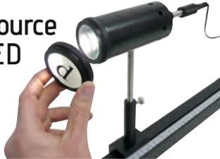
Cette source tire sa luminosité d'une LED monobloc de puissance. Elle est suffisamment lumineuse pour des expériences élève, même dans des pièces éclairées. Dotée d'un réglage par tirage, d'un condenseur et d'un objet "d" amovible, elle peut être utilisée dans toutes les applications courantes.
