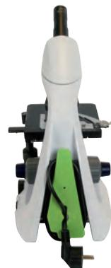
↑ Le range-câble d'alimentation intégré au statif permet le rangement et le transport sans gêne du microscope.
