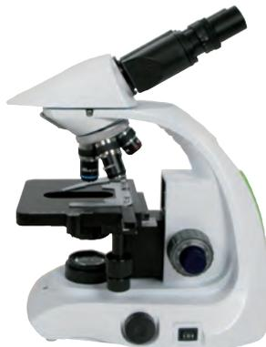
↑ Sa forme et conception unique protègent les commandes de tout dommage : rotation de la tête à 180° pour limiter l'encombrement et permettre le rangement facile.
