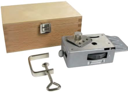
Petit et tout en inox, ce microtome équipé de sa lame à rasoir facilement interchangeable permet l'obtention rapide de coupe de qualité.
