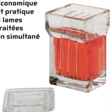
Permet le traitement simultané de 8 lames.
