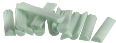
Pour réaliser des préparations microscopiques, ces tiges de polymère de dimensions adaptées aux microtomes permettent de maintenir facilement les échantillons pour réaliser des coupes végétales.
