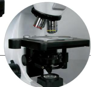
Le condenseur d'Abbe à ouverture numérique O.N. 1,25 et pré-centré est ajustable en hauteur par un mouvement linéaire. Il est équipé d'un diaphragme à iris avec guide de position utilisable en fonction de l'objectif utilisé.
