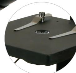
La **platine** d'une dimension de 132 x 142 mm est équipée d'une **surplatine à mouvements orthogonaux** (course 75 (X) x 40 (Y) mm avec vernier au 1/10° sur les 2 axes) avec **commandes verticales basses**. Le modèle référence 571397 existe avec une platine à valets.
