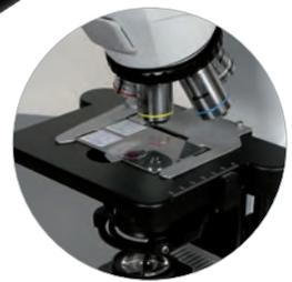
La platine d'une dimension de 150 x 133 mm est dotée d'une commande de mise au point par vis macrométrique et micrométrique (graduation 2µm) coaxiale et d'une surplatine à mouvements orthogonaux (course 75 mm [X] x 50 mm [Y] avec vernier au 1/10° sur les 2 axes) par commandes verticales. Le guide-objet permet de recevoir et comparer 2 lames en simultanée. La butée de protection est réglable et évite la casse des lames lors de l'observation.
