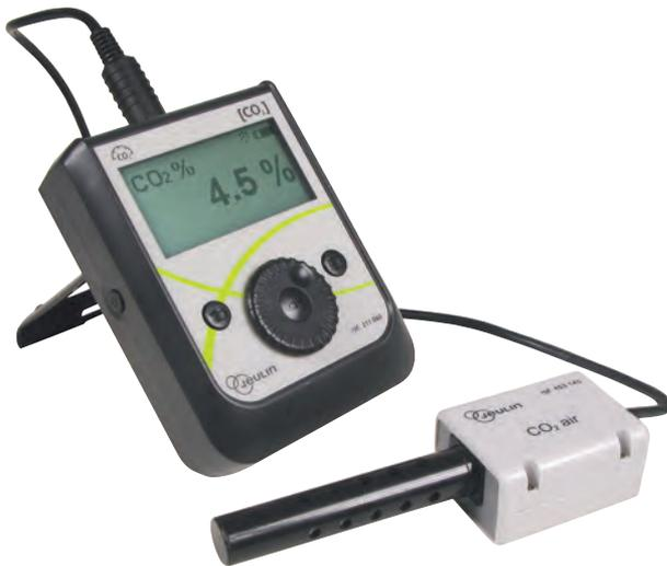
Cet Initio® 2, basé sur la technologie infrarouge, mesure le taux de CO<sub>2</sub> dans l'air. Il convient parfaitement à l'étude de l'augmentation de la concentration en CO<sub>2</sub> dans l'air expiré lors d'un effort physique, des besoins d'une cellule chlorophyllienne ou encore la combustion de ressources fossiles.
