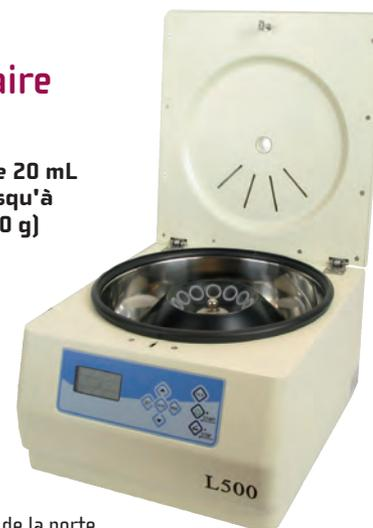
Verrouillage électronique de la porte. Frein en fin de centrifugation par inversion du sens de rotation par un bouton-poussoir. Réglage de la vitesse par variateur électronique. Minuterie réglable entre 0 et 99 minutes.
