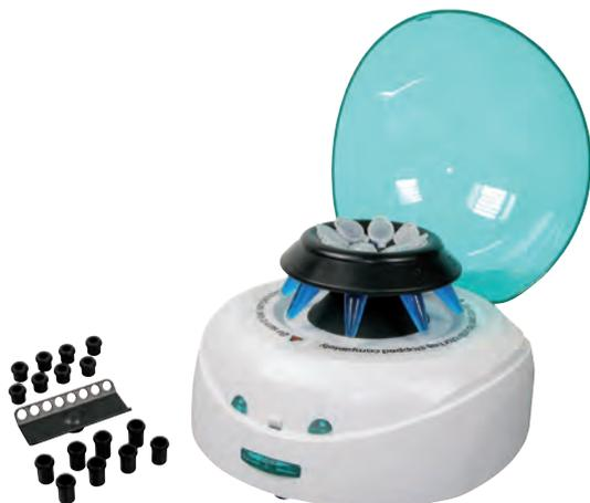
Facile à utiliser, cette micro-centrifugeuse est recommandée pour les travaux de courte durée comme les séparations micro-cellulaire. 2 modes de fonctionnement :
