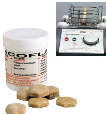
Produit d'origine naturelle produisant une flamme pendant une minute sans dégager d'émanation toxique. Poser la pastille directement sur la grille du bec électrique qui s'enflamme uniquement à haute température et s'éteint spontanément en cas de chute hors de la zone chauffée.
