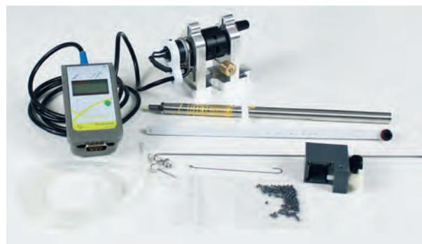
La tige de maintien de la préparation peut être déplacée pour augmenter le bras de levier du système. Les masselottes réglables permettent un équilibre parfait du montage quelles que soient vos conditions de mesure.
