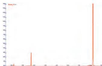
Spectre d'émission de la lampe à mercure avec visibilité du doublet
