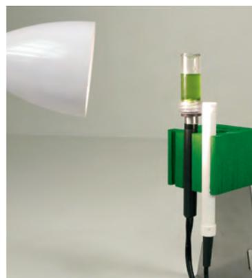
La micro-enceinte est spécialement conçue pour la sonde O<sub>2</sub> optique, afin d'obtenir des résultats rapides et garantis lors de vos TP de photosynthèse ou de respiration.
