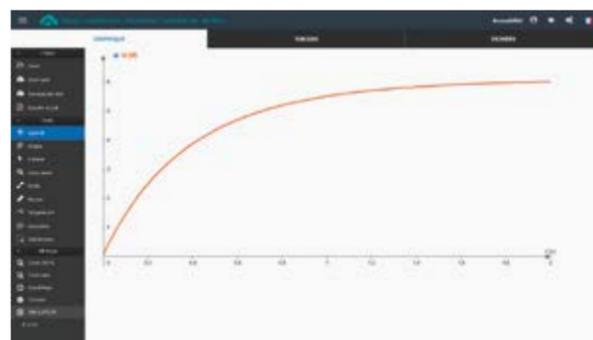
> Lab Web : courbe de charge d'un condensateur
