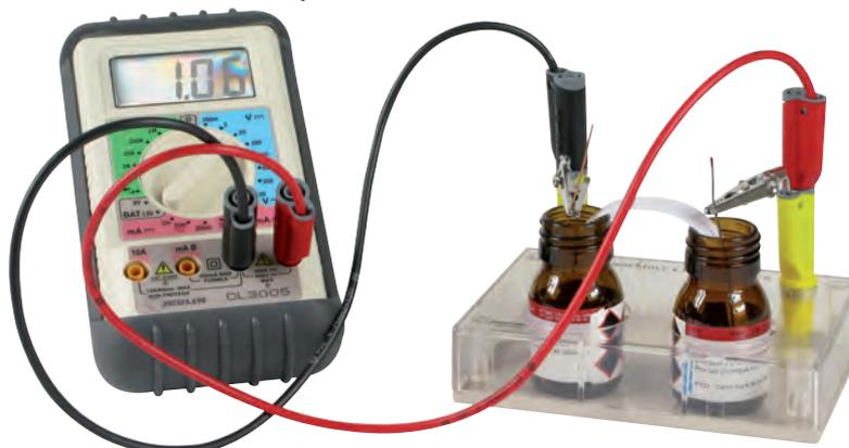
Cet ensemble complet permet d'étudier jusqu'à 10 piles en combinant 5 couples rédox ( $\text{Ag}^+/\text{Ag}$ ,  $\text{Cu}^{2+}/\text{Cu}$ ,  $\text{Al}^{3+}/\text{Al}$ ,  $\text{Fe}^{2+}/\text{Fe}$ ,  $\text{Zn}^{2+}/\text{Zn}$ ) deux à deux.
