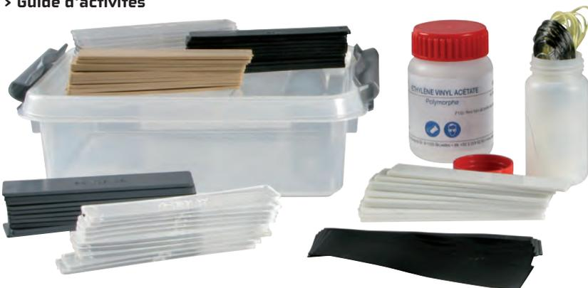
Cette mallette permet de réaliser de nombreux tests sur 6 matières plastiques. On peut aborder par exemple le test de densité, leurs comportements lors du pliage, le test de résistance aux solvants...
