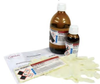
Kit permettant de produire 500 mL d'une solution de brome à 30 g/L (env.) en milieu acide.
