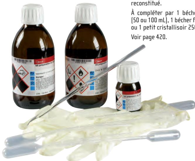
Un film de nylon est formé à l'interface de 2 liquides non miscibles. Lorsque l'on tire ce film hors du cristalliseur dans lequel il s'est formé afin d'obtenir un filament, ce film est immédiatement et régulièrement reconstitué.
