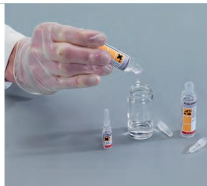
↑ Préparation du milieu réactionnel : mélange du contenu des 3 ampoules sécables.
