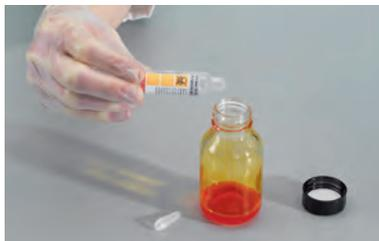
Kit permettant de produire 5 x 100 mL d'eau de brome à 3 g.L<sup>-1</sup>, prête à l'emploi.
