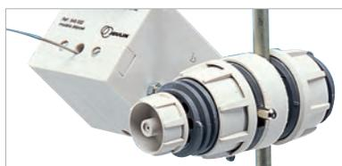
↑ Fixe les tiges fines grâce à la vis de serrage.
