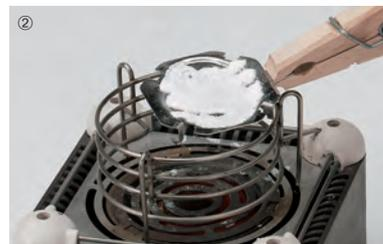
① et ② Évaporation d'une solution de chlorure de sodium.
