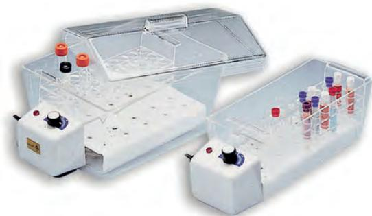
Ils peuvent être complétés par un portoir pour tubes de diamètre 14 ou 20 mm, un couvercle forme toit et un thermomètre coudé.
