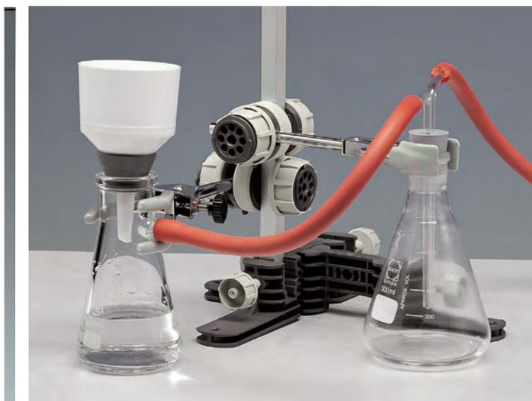
↑ Exemple de support pour montage de filtration sous vide (réalisé à partir du statif Modumontage®).
