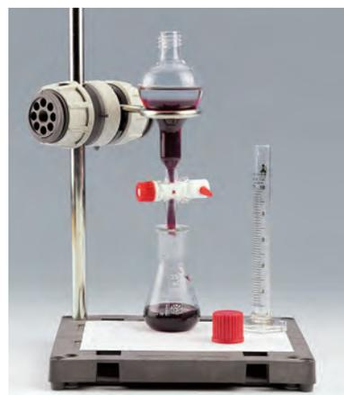
↑ Exemple de support pour montages légers particulièrement adapté pour la Microchimie (réalisé à partir du support Modumontage® économique).
