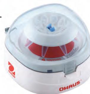
La FRONTIER FC5306 est une petite centrifugeuse permettant un traitement sur des échantillons de faible volume, elle assure une grande sécurité à son utilisateur grâce à sa sonde de détection.
