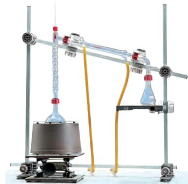
↑ Exemple de support pour montage de distillation fractionnée.
