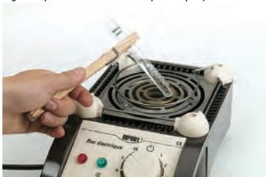
Le tube est introduit dans l'orifice central de la grille au plus près de la résistance pour des manipulations nécessitant un fort apport calorifique (réaction Fe/S, pyrolyses, production d'alliages...).
