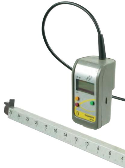
Il mesure le champ magnétique selon deux axes orthogonaux à l'aide d'une sonde biaxiale graduée (fournie).
