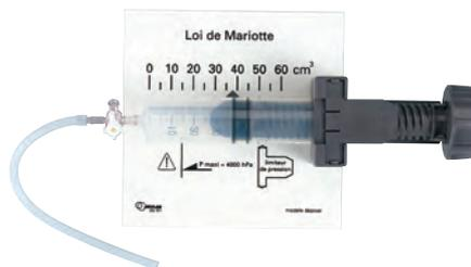
La seringue à piston vissant, montée sur socle, permet de faire varier et de maintenir la pression précisément et sans effort. Une butée escamotable permet de limiter la pression, afin de protéger le capteur pression connecté au dispositif. La vanne 3 voies assure le remplissage de la seringue et la connexion au capteur pression.
