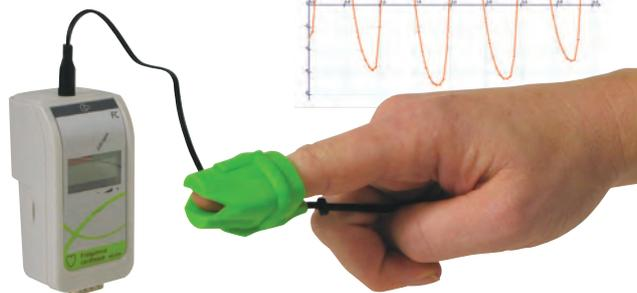
Ce capteur donne la valeur de la fréquence cardiaque en battements par minute à l'aide d'un capteur optique dans lequel l'utilisateur insère son doigt. Dans le logiciel Atelier Scientifique, il est possible de représenter la forme d'un signal cardiaque afin d'en mesurer la période.
