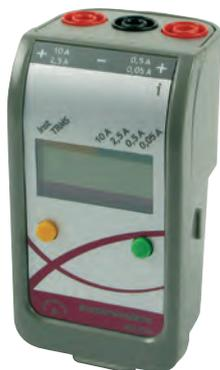
Mesure différentielle instantanée et efficace vraie de l'intensité via 2 douilles de sécurité 4 mm. La mesure peut être lue directement sur le capteur, cet usage est très pratique pour réaliser une mesure simple ou un contrôle. 4 calibres sont disponibles pour de multiples usages : étude de l'électromagnétisme, de l'électricité...
