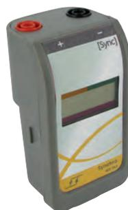
Il permet de synchroniser l'acquisition sur un événement extérieur avec la console AirNeXT® notamment lors d'études des ondes sismiques et de la vitesse du son dans l'air et dans l'eau.
