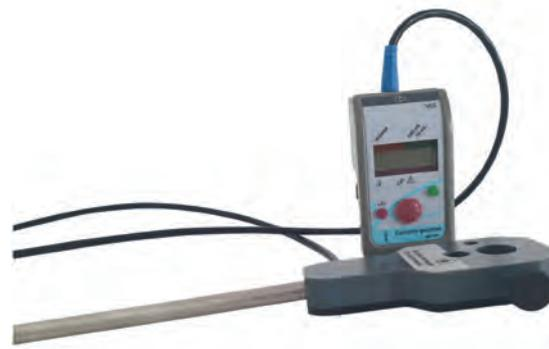
Associé à un capteur pH ou conductimètre, ce capteur compte-gouttes permet la réussite de vos dosages et titrages ph-métriques ou conductimétriques.
