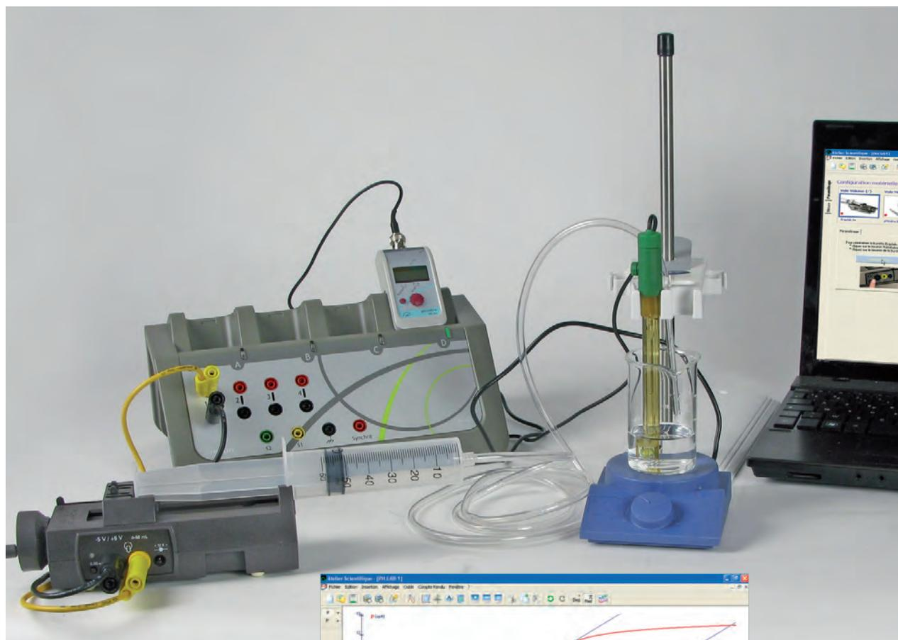
Le but de ce TP est de déterminer la concentration d'une espèce chimique par suivi du pH. Lors de ce dosage, le volume versé est numérisé avec la burette Ergolab®. Ainsi, l'utilisateur évite les erreurs de lecture et obtient en fin d'acquisition un nombre important de points pour saisir au mieux le saut de pH.
