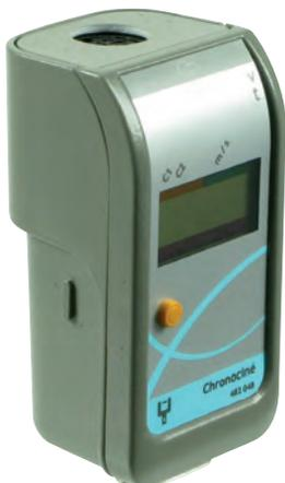
Associé aux fourches Chronociné (ci-contre), ce capteur permet de déterminer le temps de passage et la vitesse instantanée d'un mobile ou d'une bille.
