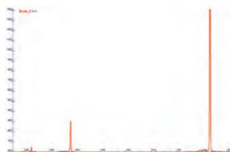
Spectre d'émission de la lampe à mercure avec visibilité du doublet
