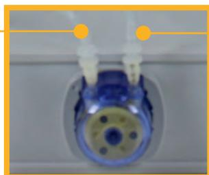
Tuyau de prélèvement de la solution
