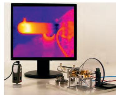
Etude de transfert thermique : Exemple avec un moteur Stirling
