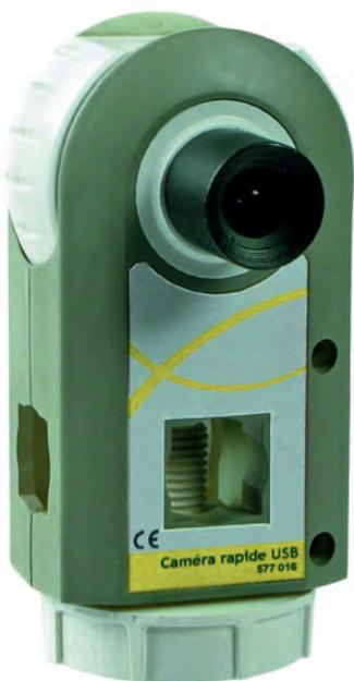
Spécifiquement conçues pour répondre à vos besoins en acquisitions, cette caméra est un outil indispensable pour l'étude de la mécanique (mouvements, pendule, chute, etc.).
