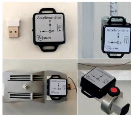
Accessoires fournis pour la fixation du capteur à différents montages
