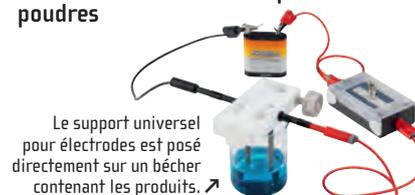
Le support universel pour électrodes est posé directement sur un bécher contenant les produits.
