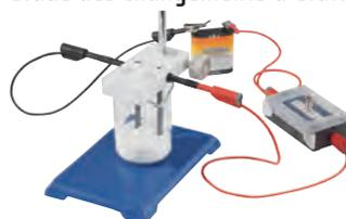
↑ Le support universel pour électrodes est fixé sur un statif au-dessus du bécher contenant les produits.
