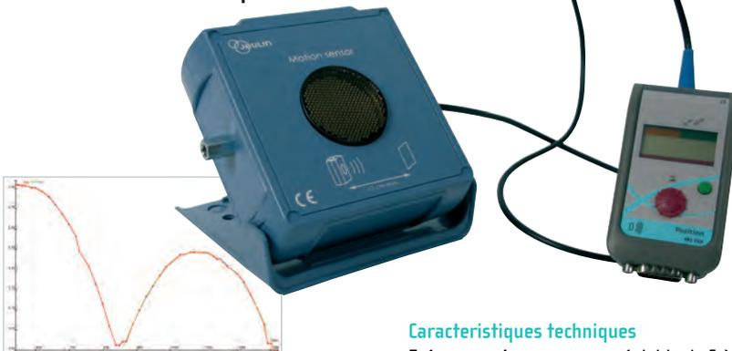
Ce capteur permet de mesurer la position des objets se mouvant dans son champ de détection jusqu'à 10 m de distance.
