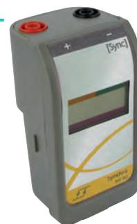
Il permet de synchroniser l'acquisition sur un événement extérieur. Il peut être utilisé avec un capteur Sismo pour étudier les ondes sismiques ou avec un capteur Sonomètre pour mesurer la vitesse du son.
