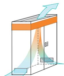
L'air de l'armoire est aspiré mécaniquement et passe à travers un filtre qui fixe les polluants, l'air est ainsi purifié et recyclé dans la pièce.
