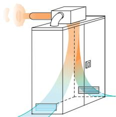
L'armoire est raccordée à l'extérieur du bâtiment via un conduit et l'air contenu dans l'armoire est expulsé mécaniquement en continu.
