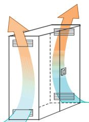
L'air circule naturellement entre l'intérieur de l'armoire et le local de stockage par des ouvertures basses et hautes. Ce système évite toute accumulation dangereuse de vapeurs dans l'armoire mais ne protège pas l'atmosphère du lieu de travail des émanations.
