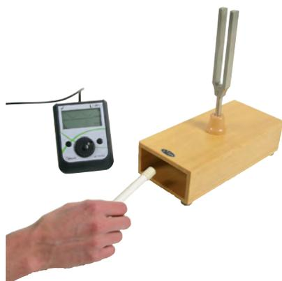
Détermination de la fréquence du signal sonore avec la fonction "accordeur"
