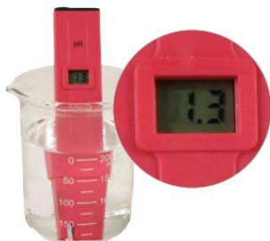
1 - Verser de l'acide chlorhydrique 1 mol/L dans un bécher et mesurer le pH.
