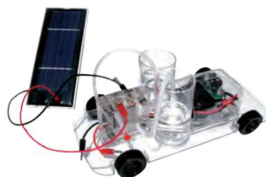
La pile à combustible réversible PEM combine l'électrolyse et la conversion en puissance électrique en un seul appareil.
