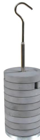
Ces masses échancrées sont idéales pour les TP de mécanique statique.
