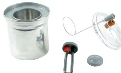
Ce calorimètre est composé de deux enceintes en aluminium, séparées par un vase en polystyrène pour renforcer l'isolation, le tout étant maintenu par une couronne en plastique. Le couvercle transparent dispose d'ouvertures prévues pour un thermomètre  $\varnothing$  6 mm, pour l'agitateur et pour un support de résistance avec connexion par douille de sécurité. Un jeu de 3 résistances de valeurs différentes permet de faire varier la puissance de chauffe.
