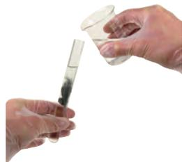
2 - Mettre de la laine de fer et verser l'acide chlorhydrique dans le tube à essai.
