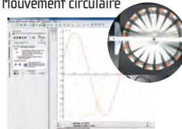
Graphique des positions en fonction du temps dans le cas d'un mouvement circulaire uniforme
