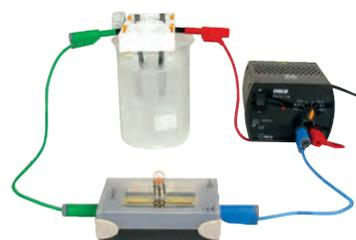
↑ L'ampoule s'allume, la conductivité a augmenté.
