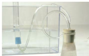
4 - Une vive effervescence se produit qui prouve qu'il y a réaction chimique entre la craie et l'acide chlorhydrique.
