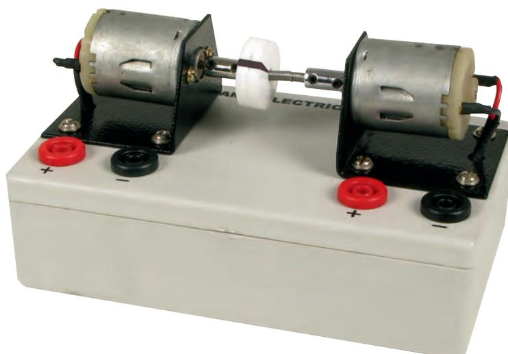
2 moteurs électriques à courant continu sont reliés mécaniquement au niveau de leurs arbres de sortie. L'un fonctionne donc en moteur, tandis que l'autre se comportera en génératrice. L'élève réalise ainsi une conversion électrique-mécanique qui se traduira par la rotation de l'arbre moteur, le disque stroboscopique facilite l'observation. Puis il réalise une conversion mécanique-électrique par le biais de la génératrice pour produire une tension, qu'il pourra utiliser pour alimenter un dipôle.
