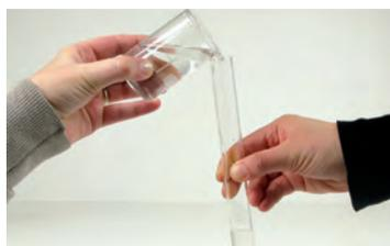
5 - Verser la solution dans un tube à essais, puis ajouter de l'eau de chaux.
