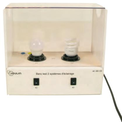
Le banc de test permet de mesurer en toute sécurité la consommation électrique, l'efficacité lumineuse de 2 technologies d'ampoules (LED et fluocompacte). L'élève pourra donc mesurer les consommations pour chacune des ampoules que vous aurez choisies avec un énergie-mètre qui se branche directement sur la prise électrique d'alimentation du banc. Il
