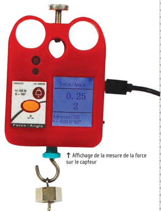
↑ Affichage de la mesure de la force sur le capteur
