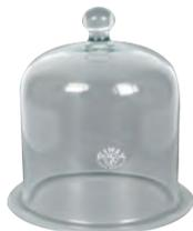
Cloche idéale pour mettre en oeuvre des expériences sur platine à vide afin de montrer que les ondes mécaniques ont besoin d'un milieu matériel pour se propager, ou encore d'étudier la température d'ébullition en fonction de la pression, ou la loi des gaz avec des ballons de baudruche.
