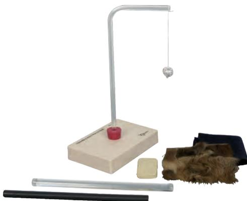
Ensemble permettant la mise en évidence des phénomènes électrostatiques d'attraction et de répulsion.
