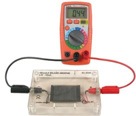
Mettre une cellule solaire sous une source lumineuse, et relever la tension électrique générée avec un multimètre.
