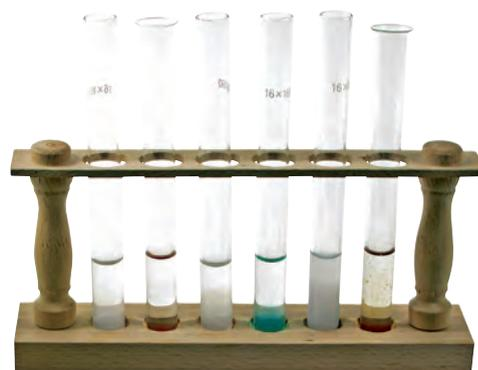
Ces solutions sont conçues pour mettre en évidence différents ions, par la formation d'un précipité en solution aqueuse. Le temps de réaction permet aux élèves d'observer les différents milieux. Il est possible de réaliser jusqu'à 10 tests pour chaque ion. Solutions conçues pour mettre en évidence les ions :  $\text{Ag}^+$ ,  $\text{Cu}^{2+}$ ,  $\text{Fe}^{2+}$ ,  $\text{Fe}^{3+}$ ,  $\text{Zn}^{2+}$ ,  $\text{Cl}^-$ .
