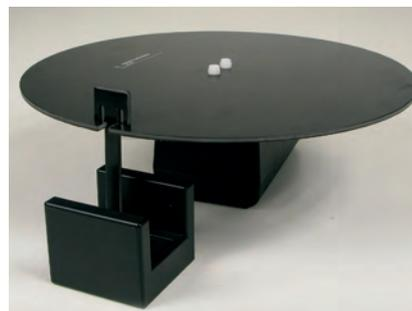
← Mesure du temps de rotation du disque pour caractériser le mouvement
