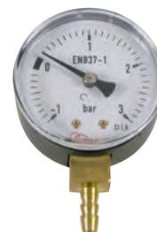
Ce manomètre permet de réaliser des mesures simples lors d'une mise sous pression ou la réalisation d'un vide partiel. Le cadran sérigraphié au 1/10 offre une gamme de mesure de -1 bars jusqu'à 3 bars, ce qui se prête à une utilisation avec la maquette loi de Mariotte par exemple.
