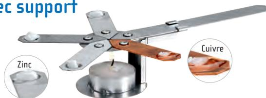
L'étoile est placée au-dessus de la flamme d'une bougie type chauffe-plat après avoir déposé dans chacune des coupelles un petit morceau de paraffine. La conduction thermique de chaque métal peut être évaluée qualitativement en relevant le temps que met chaque morceau de paraffine à fondre.
