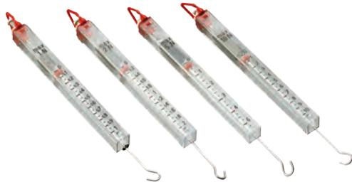
Dynamomètres pouvant être utilisés dans l'eau.
