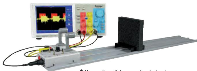
↑ Mesure d'une distance sur le principe du sonar
