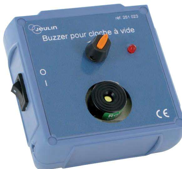
Ce buzzer monté sur une mousse pour éviter toute propagation du son par vibration, est idéal pour mettre en évidence la décroissance du son lors d'une baisse de pression pour justifier que le son a besoin d'un milieu matériel pour se propager.
