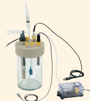
Organisé autour d'une enceinte en verre de 2 litres il dispose de 4 emplacements Ø 12 mm pour les sondes O<sub>2</sub>, CO<sub>2</sub>, Ethanol et turbidimètre et de 2 emplacements Ø 6 mm pour thermomètre et luxmètre.
