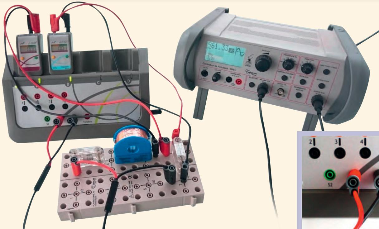
L'objectif de ce TP est de mesurer la réponse en intensité ou en tension d'un circuit RLC série soumis à la tension sinusoïdale d'un GBF.
