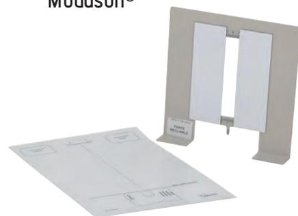
Dispositif muni d'une fente réglable de 0 à 40 mm permettant de visualiser les minima et maxima de diffraction des ondes ultrasonores.
