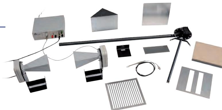
Ensemble permettant de faire l'analogie de l'optique avec des ondes électromagnétiques de longueur d'onde centimétrique.
