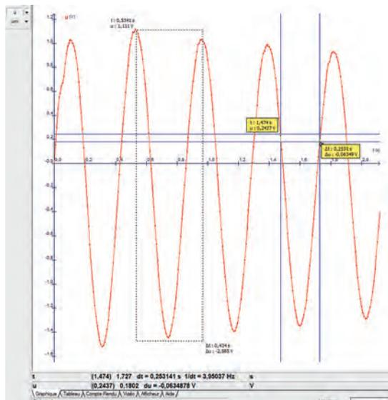
Exemple d'application : Détermination de la période et de l'amplitude crête à crête avec le pointeur →
