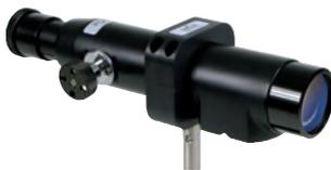
La lunette de visée a pour rôle principal le réglage de la mise à l'infini du collimateur. Elle peut aussi viser à distance finie.
