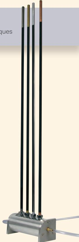
Ce dispositif expérimental permet l'étude de la conduction thermique dans différents barreaux métalliques, en régime permanent.
