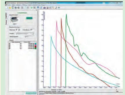
2 - Pour chaque courbe, on détermine la vitesse initiale  $V_i$  de la réaction, grâce à l'outil tangente à l'origine du module Enzymo
