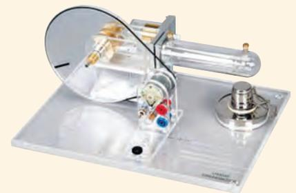
Le système est constitué d'un cylindre thermorésistant chauffé par un réchaud à alcool à mèche, d'un piston qui, par l'intermédiaire d'un vilebrequin en acier durci, entraîne une roue volante en verre acrylique, elle-même entraînant un moteur à courant continu.
