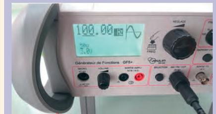
Connexion du GBF à la voie de pilotage Foxy, Mode piloté
