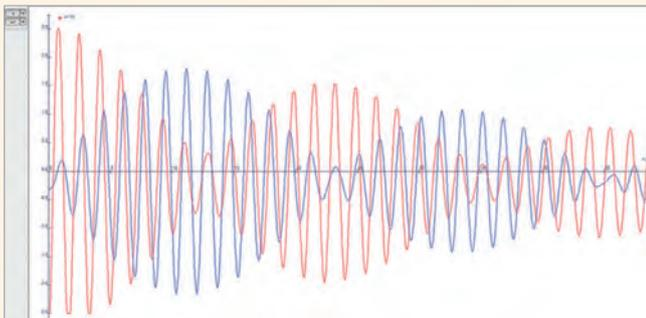
Enregistrement simultané des deux pendules couplés dans l'A.S. Sup
