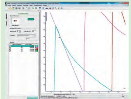
3 - On construit le courbe paramétrique des  $V_i$  mesurées en fonction du paramètre étudié. Les outils à disposition permettent la détermination de la  $V_{max}$  et du  $K_m$ .
