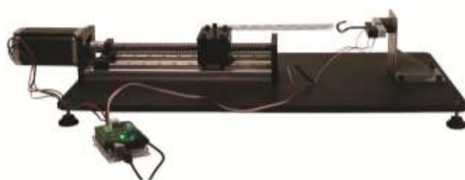
Traction d'un ressort
