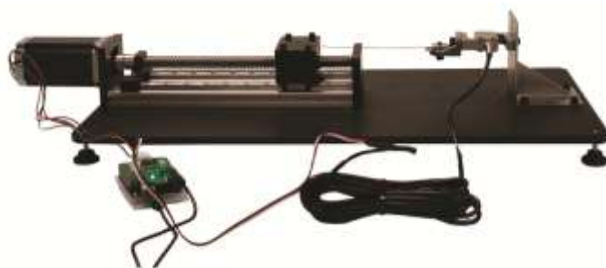
Traction d'un fil d'acier
